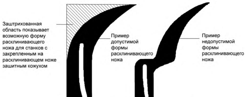
Рисунок 10 – Форма раскливающего ножа
