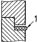
Неэластичный материал прокладки деформируется под давлением. Периодическое изменение температуры вызовет постоянную утечку из-за большой разницы между коэффициентами теплового расширения металла и пластика
