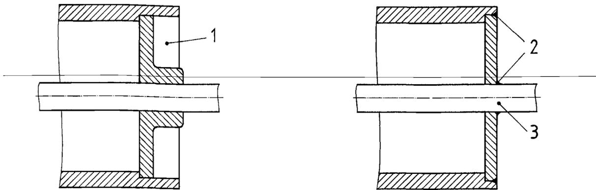
б) конструкция роликового конвейера
