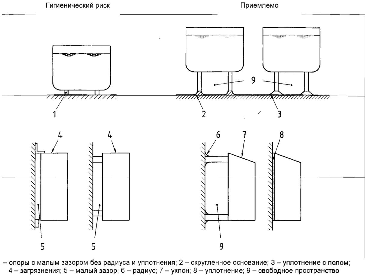
Рисунок В.13 – Крепления к полу и стене
