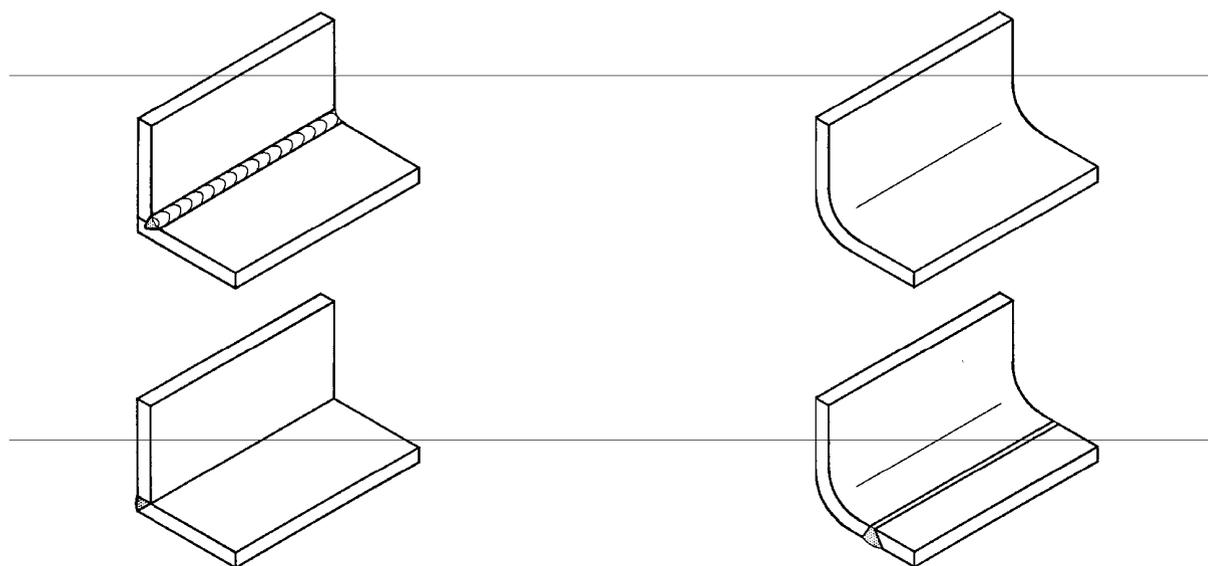
Рисунок В.6 – Внутренние углы и кромки
