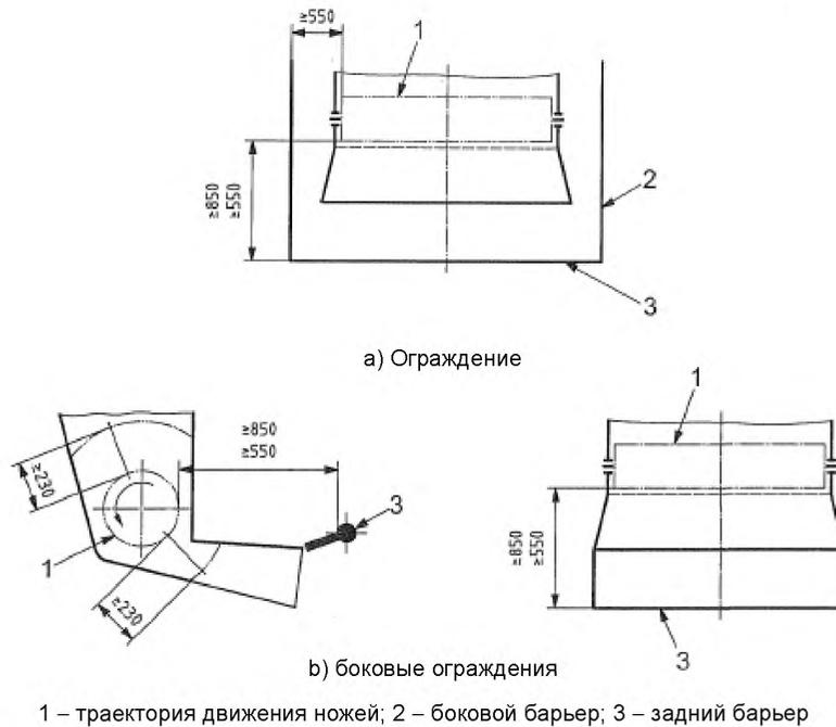
Рисунок 12 – Ограждения измельчителя соломы с разгрузочным желобом
