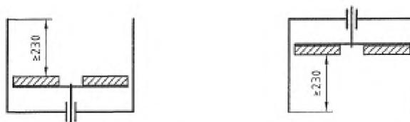
Рисунок 13 – Ограждение привода распределителя соломы
