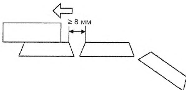
Рисунок 9 – Элемент конструкции цепного механизма подачи
