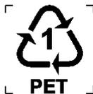
Рисунок С.1 — Полиэтилентерефталат (PET)
