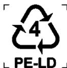
Рисунок С.4 — Полиэтилен низкой плотности (PE-LD)
