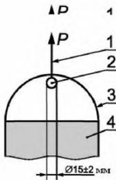
1 — разрывающее усилие; 2 — приспособление, имитирующее сосредоточенную нагрузку; 3 — испытываемая ручка тары; 4 — испытываемая тара
