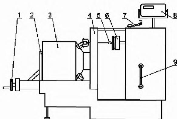
Б.2 суреті — Электрондық күш өлшеуді қолдану арқылы ыдыс элементтерін беріктікке сынауға арналған стенд сызбанұсқасы
