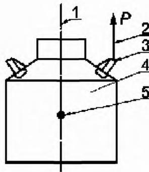
1 — вертикальная ось тары; 2 — направление усилия, прилагаемого к ручке тары; 3 — испытываемая ручка; 4 — испытываемая тара; 5 — центр тяжести испытываемой тары
