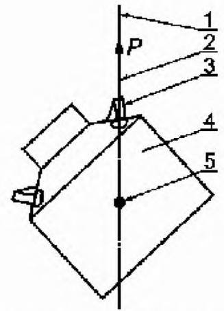
1 — линия, проходящая через центр тяжести и ручку; 2 — направление усилия, прилагаемого к ручке тары; 3 — испытываемая ручка тары при центральном расположении ручек; 4 — испытываемая тара; 5 — центр тяжести испытываемой тары
