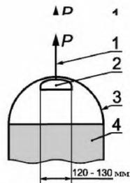
1 — разрывающее усилие; 2 — приспособление, имитирующее распределенную нагрузку; 3 — испытываемая ручка тары; 4 — испытываемая тара
