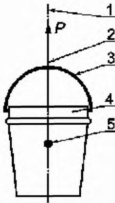
1 — линия, проходящая через центр тяжести по вертикальной оси тары; 2 — направление прилагаемого усилия в ручке тары; 3 — испытываемая ручка тары; 4 — испытываемая тара; 5 — центр тяжести испытываемой тары
