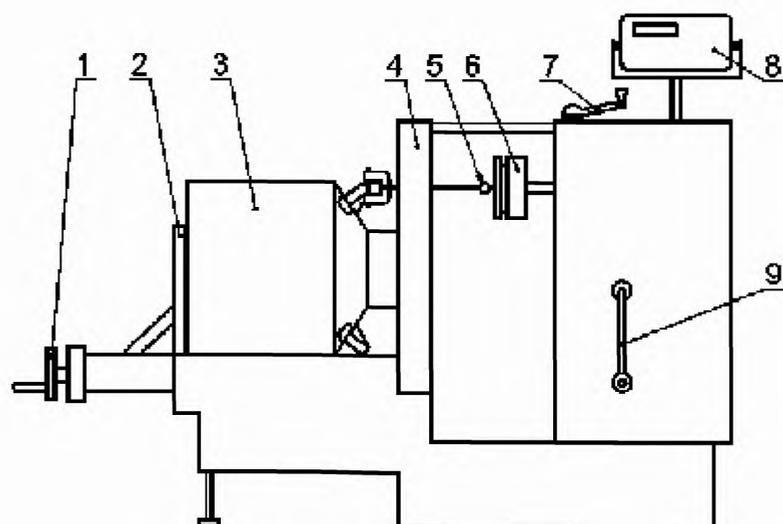
Рисунок Б.2 — Схема стенда для испытания элементов тары на прочность с применением электронного измерения усилия
