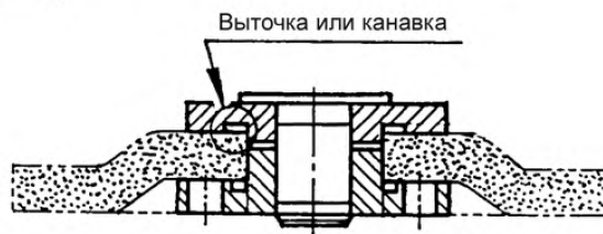
Рисунок 2 – Пример выточки или канавки на фланце
