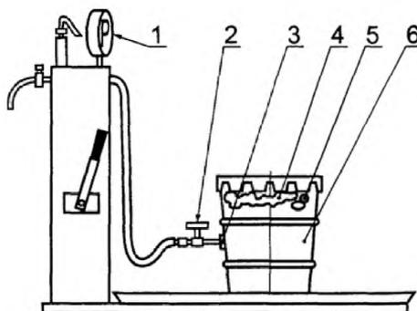
1 – манометр давления воздуха; 2 – кран пневмосистемы; 3 – врезной штуцер;
