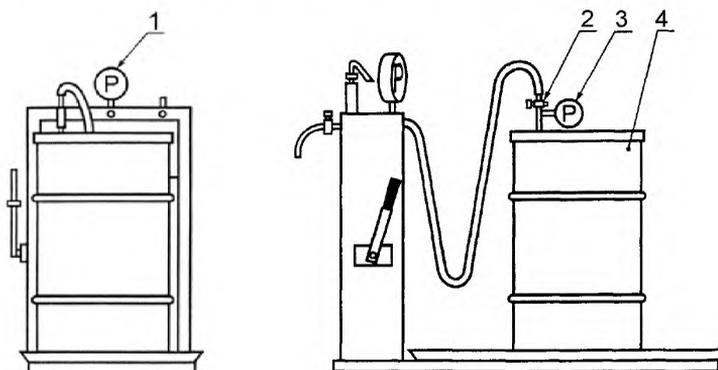
1 – манометр давления воздуха; 2 – кран пневмосистемы;
