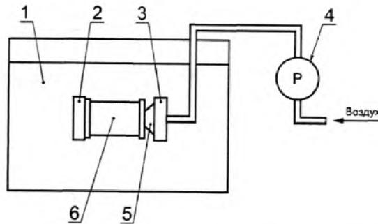
1 – испытательная камера; 2 – упор; 3 – упор со шлангом для подачи воздуха;
