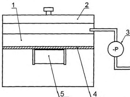
1 – вакуумная камера; 2 – крышка вакуумной камеры;
