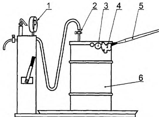
1 – манометр измерения давления воздуха; 2 – кран пневмосистемы;
