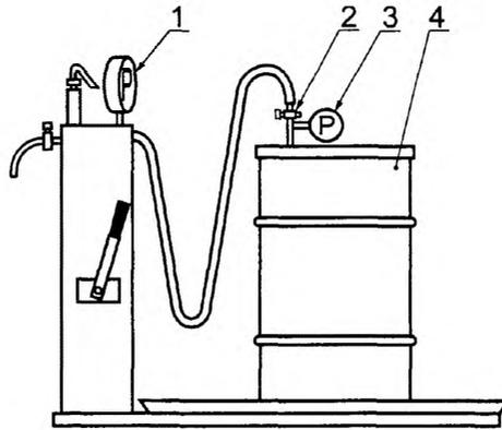
1 – манометр давления воды; 2 – кран гидросистемы;
