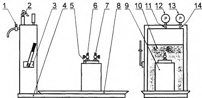
1 – редуктор; 2 – предохранительный пневмоклапан; 3 – насос; 4 – рама;
