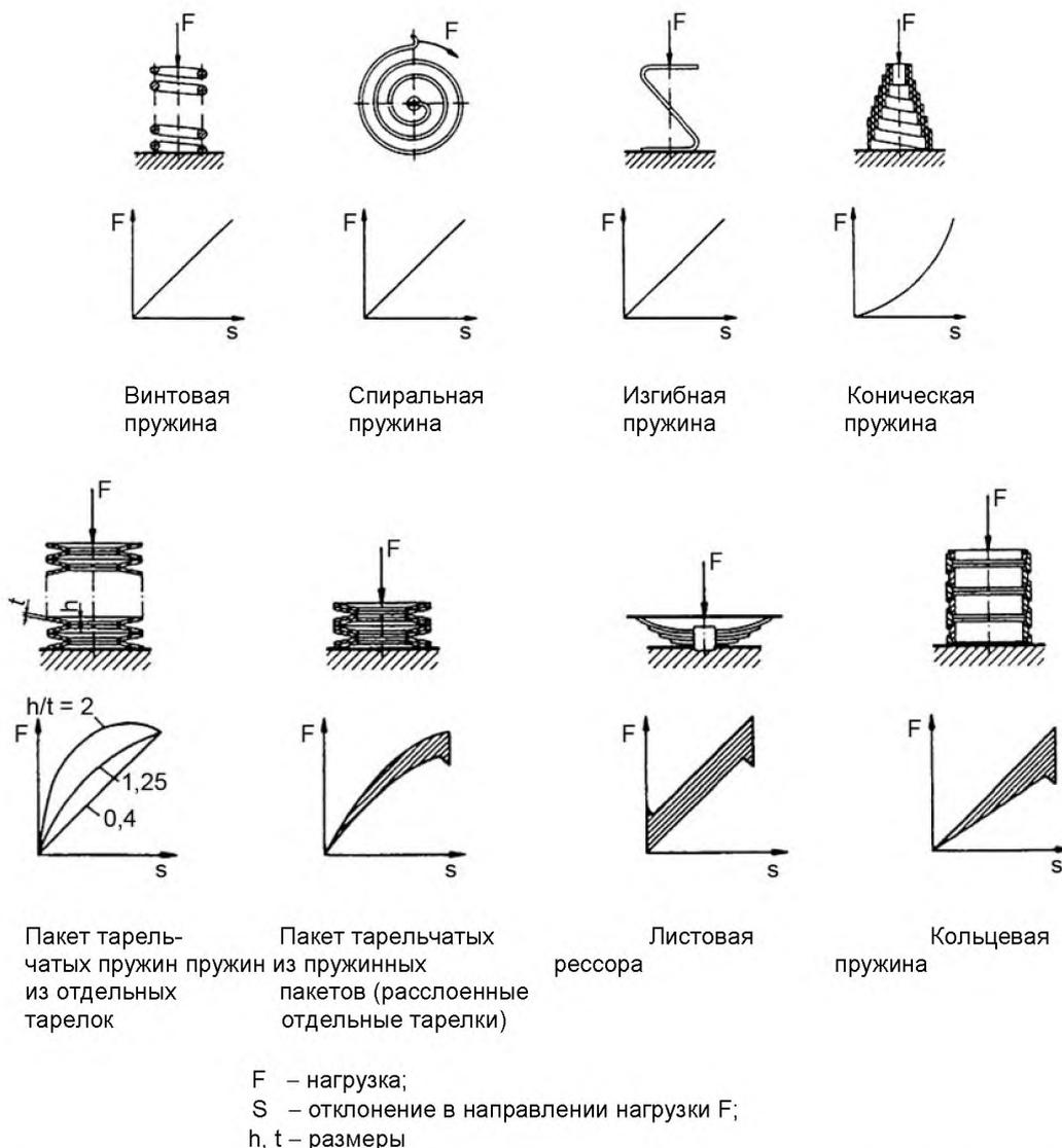
Заштрихованные области обозначают гистерезис, который получается за счет фрикционной амортизации.
