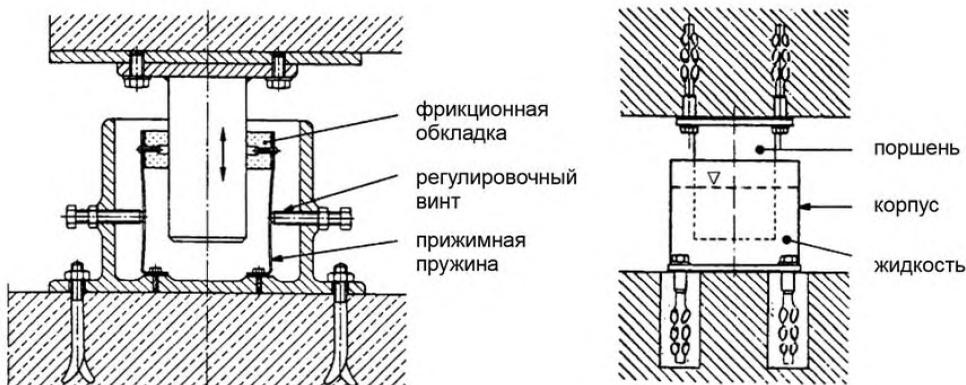
Рисунок А.5 – Конструкция фрикционного и гидравлического демпфера
