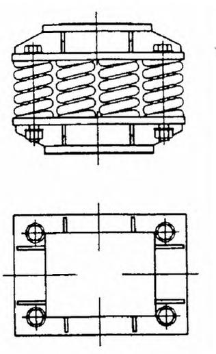
Рисунок А.3 – Типовой пружинный узел из винтовых пружин сжатия
