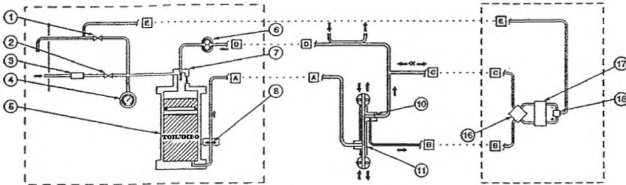
JFTOT – пневматическое повышение давления/шестеренчатый насос/
