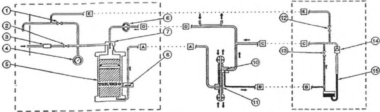
JFTOT – пневматическое повышение давления/шестеренчатый насос/
