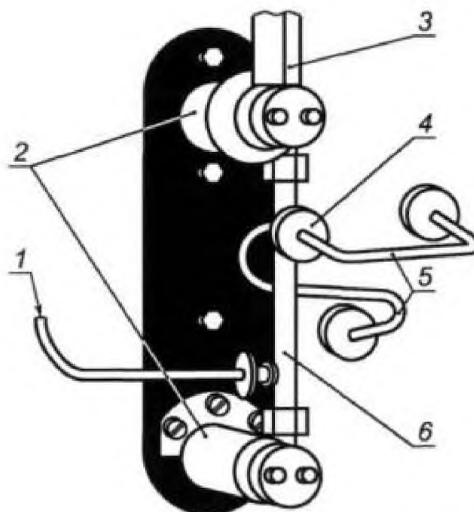
1 - впуск топлива; 2 - охлаждающие шины; 3 - термопара; 4 - испытательный фильтр;
