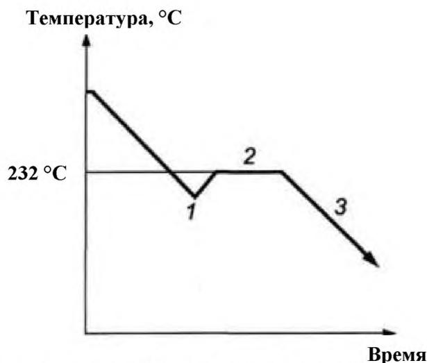
1 - переохлаждение; 2 - застывание; 3 - твердое состояние
