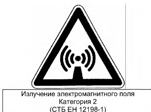
Рисунок 2 – Маркировка для электромагнитного поля, категория 2
