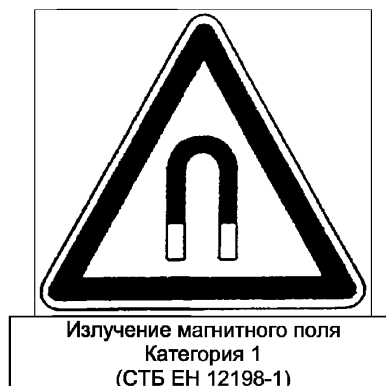
Рисунок 1 – Маркировка для магнитного поля, категория 1
