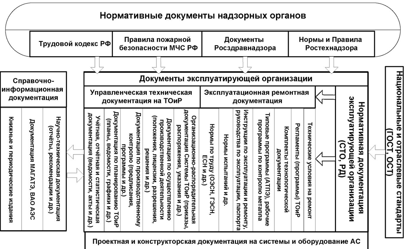
Рисунок 6.1 - Структура документации, составляющей информационное обеспечение ремонта систем и оборудования АС
