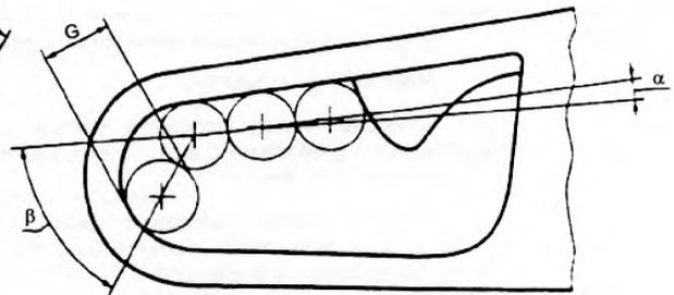
$\alpha = \text{от } -15^{\circ} \text{ до } +15^{\circ}; \beta = \text{от } -75^{\circ} \text{ до } +75^{\circ}$
