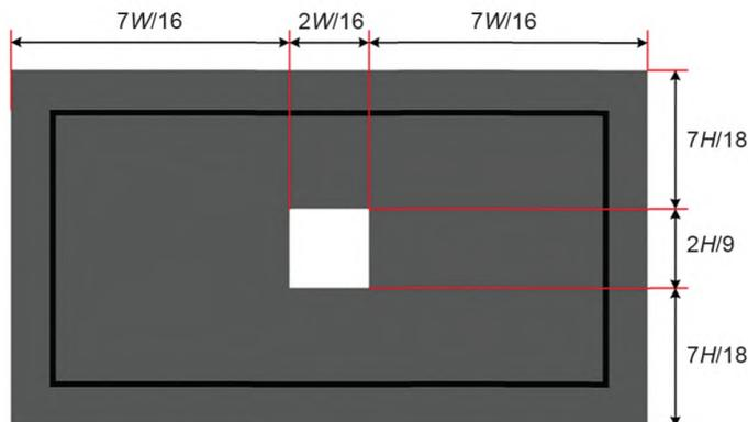
Рисунок 4 — Видеосигнал в виде прямоугольника с обводкой.
