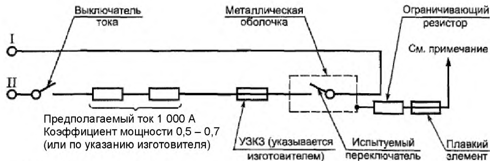
Рисунок 7 – Схема нагрузки L_d для условий испытаний, требующих различных значений токов включения и отключения и/или коэффициентов мощности (постоянной времени)
