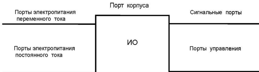
Рисунок 1 – Примеры портов устройств
