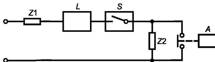
$Z1$  — сопротивление для регулировки ожидаемого тока короткого замыкания (безындуктивное);  $Z2$  — сопротивление для регулировки нагрузки (безындуктивное);  $L$  — ограничивающее устройство для величины  $I^2t$ ;  $S$  — испытуемый образец;  $A$  — вспомогательный выключатель для создания короткого замыкания
