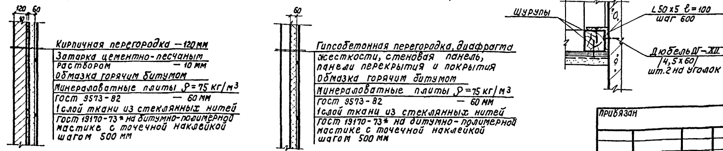
Узлы крепления изоляции к перегородкам и потолку венткамер
