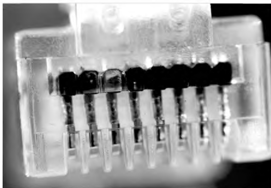
Рисунок 9 — Пример повреждения, вызванного одиночным импульсом «телекоммуникационного» генератора при напряжении 4,5 кВ
