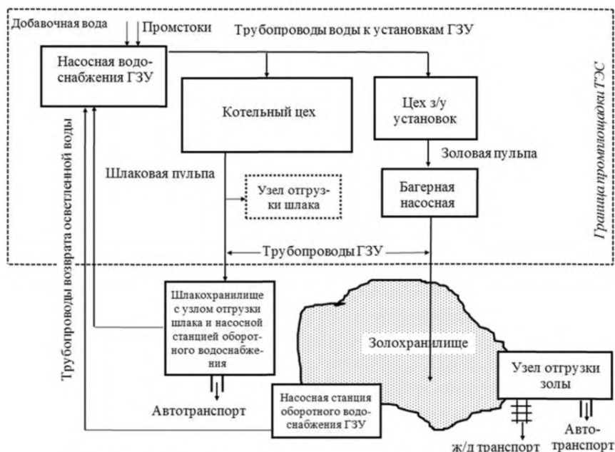
Рисунок 2.14 — Блок-схема системы ГЗУ с разделением удаления, складированием и отгрузкой золы и шлака
