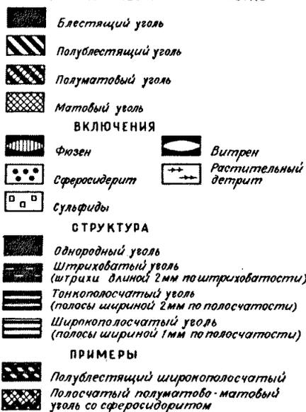
Рис.27. Условные обозначения макроструктуры и петрографических типов углей.
