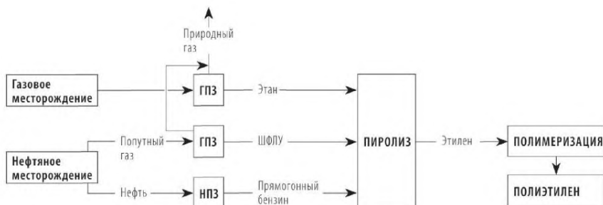
Рисунок 4.1 — Принципиальная схема производства ПЭ
