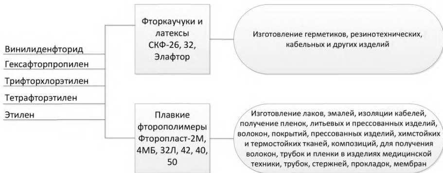
Рисунок 10.4.2 — Блок-схема распределения сырья на выпуск фторопластов
