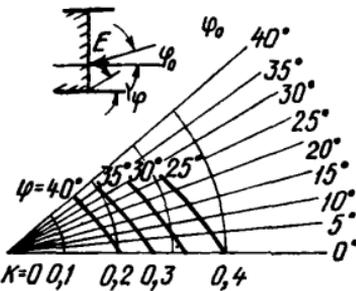
Рис. 16. Номограмма для определения коэффициента  $K$
