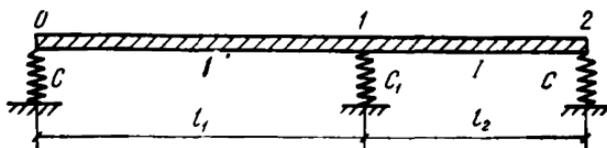
Рис. 2. Балка машинного зала с одной промежуточной опорой
