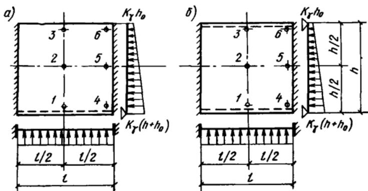
Рис. 18. К расчету подземных участков стен на поперечную нагрузку
