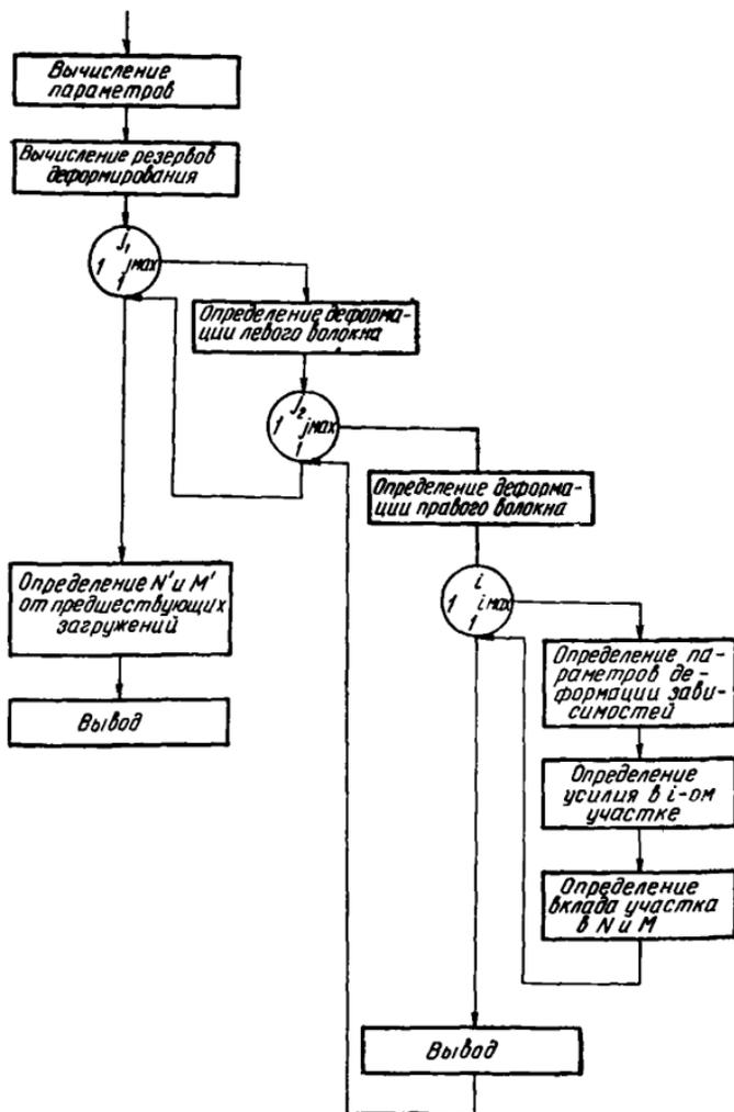
Рис. 44. Блок-схема программы «Предел»
