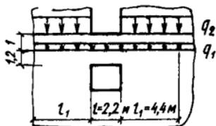
Рис. 20. Расчет обрамления проема (к примеру 2.4)
