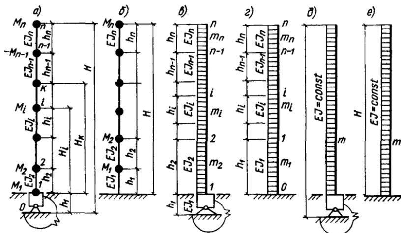
Рис. 26. Расчетные схемы башенных копров
