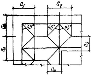
Рис. 12. К расчету опорных реакций фундаментной плиты
