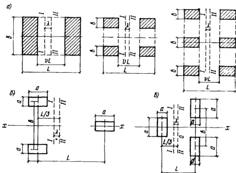
Рис. 37. Планы фундаментов в виде отдельных опор
