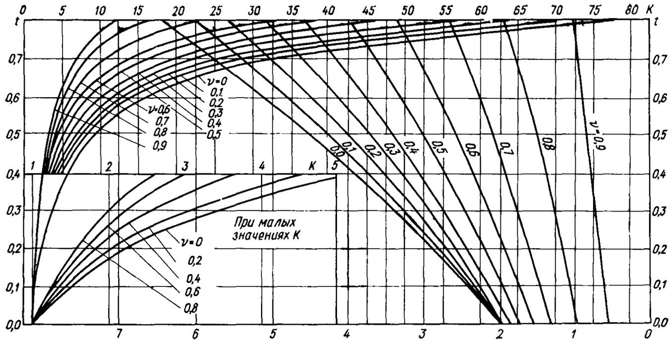
Рис. 38. Номограмма для определения коэффициентов  $t$  и  $A'$  по известным значениям  $k$  и  $\nu$  для фундаментов в виде двух прямоугольных опор
