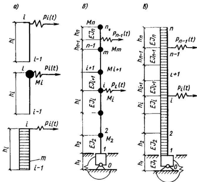
Рис. 31. Вынужденные горизонтальные колебания башенных копров: а — к решению задачи о вынужденных колебаниях методом начальных параметров в матричной форме; б, в — расчетные схемы копров с сосредоточенными и распределенными параметрами
