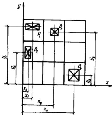
Рис. 6. Исходные данные для определения моментов вертикальных нагрузок
