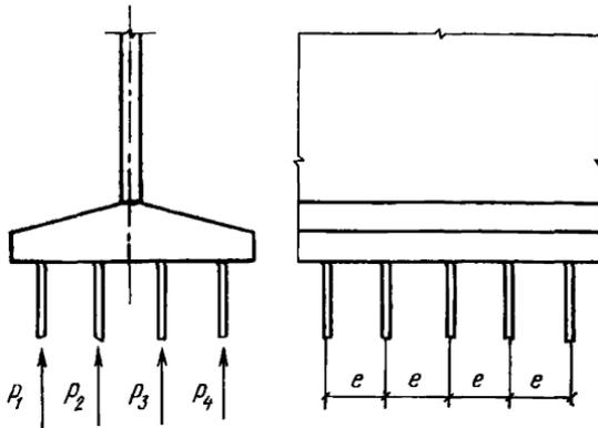
Рис. 14. К определению усилий, передаваемых на стену свайным ростверком
