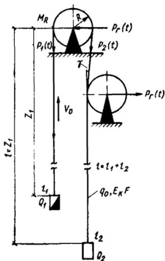
Рис. 25. Схема для определения динамических усилий в ветвях головных канатов
