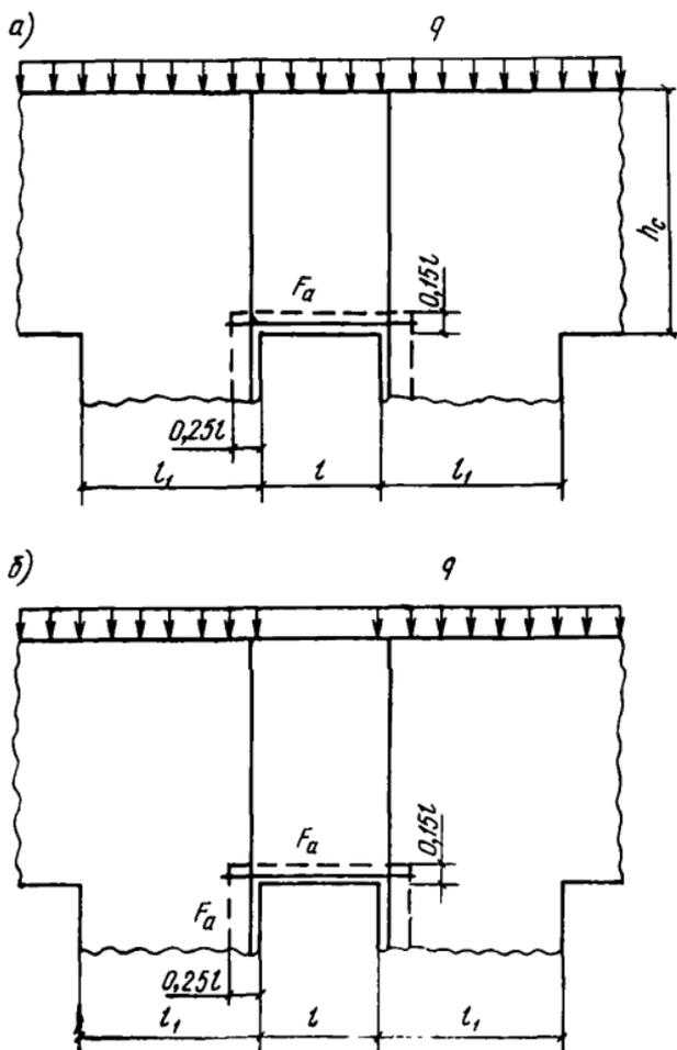
Рис. 19. Расчетные схемы участков стены
