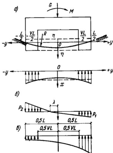
Рис. 42. Схемы эпюр отпора основания при его прогибе
