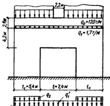
Рис. 21. Расчет обрамления проема (к примеру 2.5)
