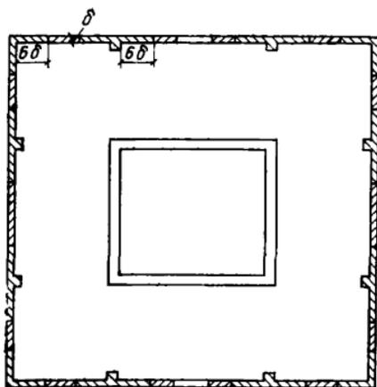
Рис. 22. Элементы сечения при расчете местной устойчивости
