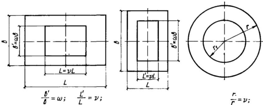
Рис. 34. Планы фундаментов различных форм
