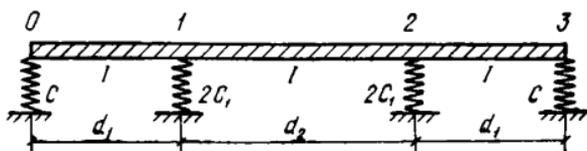
Рис. 5. Балка машинного зала с двумя промежуточными опорами
