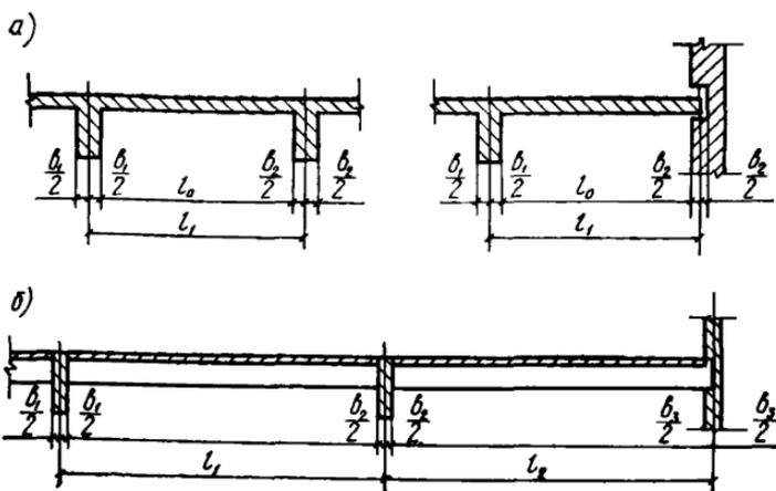
Рис. 1. Расчетные пролеты балок
