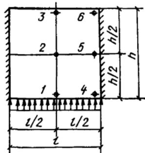
Рис. 17. Расчетные точки участка стены под проемом
