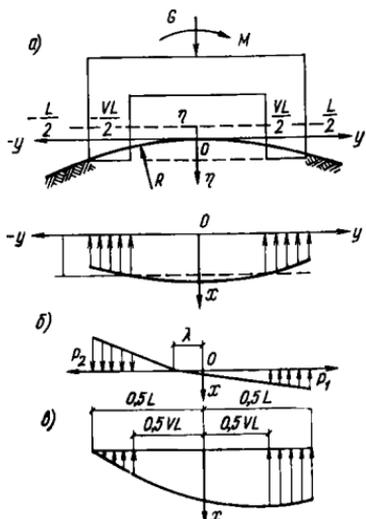
Рис. 41. Схема эпюр отпора основания при его перегибе
