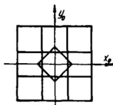
Рис. 9. Ядро поперечного сечения
