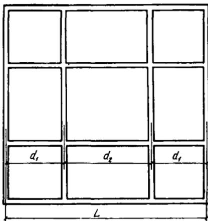
Рис. 3. План расположения опорных балок под внутренние стены
