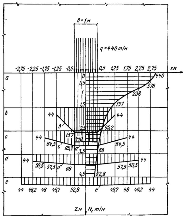
Рис. 11. Расчетные эпюры вертикальных сжимающих усилий в стене под балкой машзала (к примеру 2.2)
