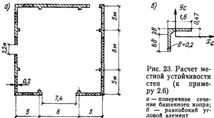
Рис. 23. Расчет местной устойчивости стен (к примеру 2.6)
