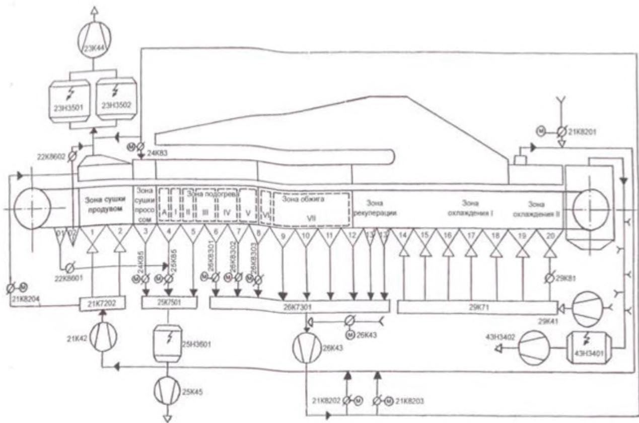
Рисунок 2.25 — Схема газовых потоков обжиговой машины Л-480
