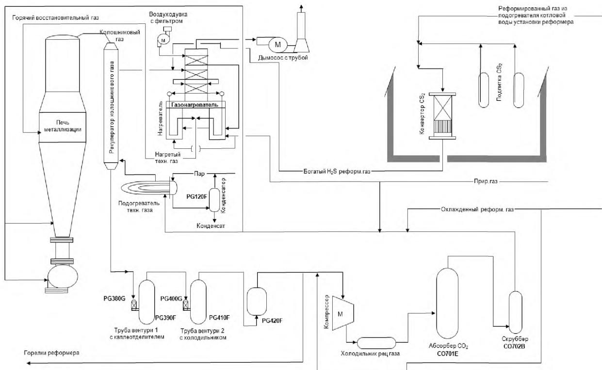
Рисунок 2.43 — Контур технологических газов установки металлизации HYL-III
