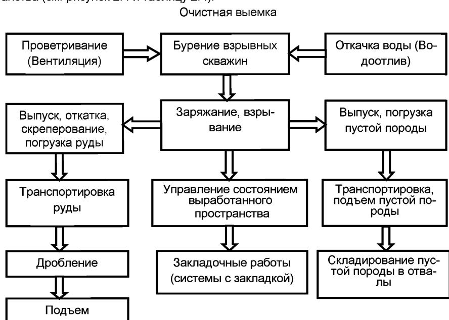
Рисунок 2.4 — Общая блок-схема процессов очистных работ
