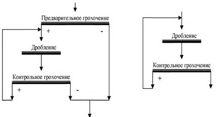
Рисунок 2.9 — Схемы одностадиального дробления в замкнутом цикле
