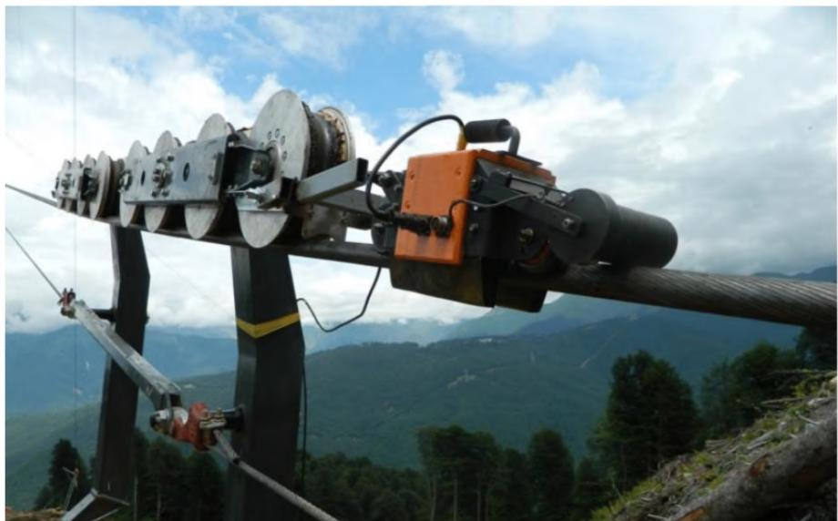
Рисунок 7.8 — Система автоматизированного мониторинга каната
