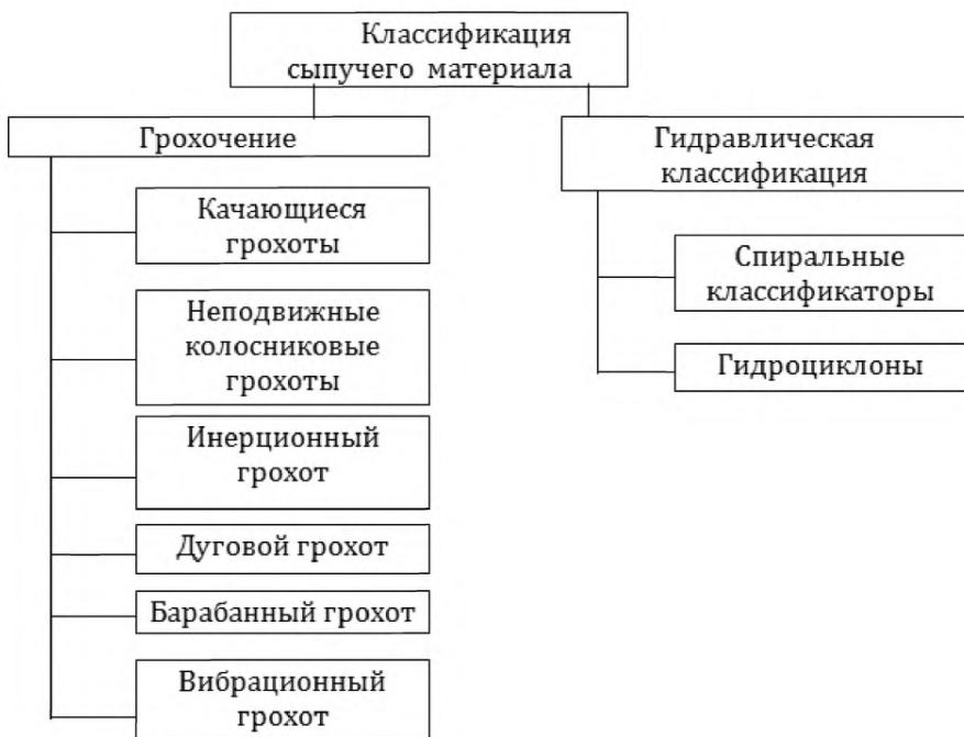
Рисунок 2.10 — Способы классификации материала
