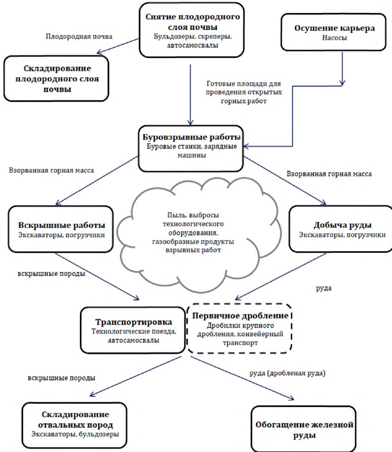
Рисунок 2.1 — Общая блок-схема процессов открытых горных работ
