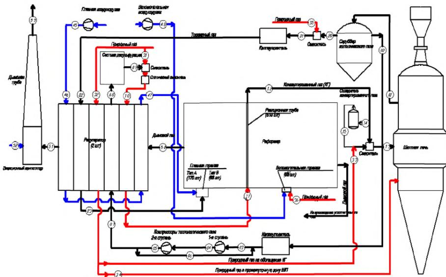
Рисунок 2.45 — Схема потоков технологических газов на установке MIDREX
