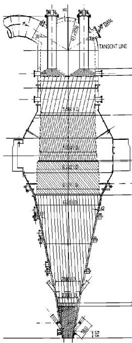
Рисунок 2.35 — Общий вид шахтной печи металлизации HYL-III
