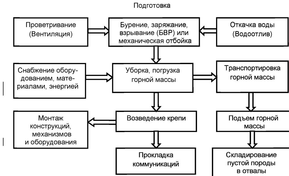
Рисунок 2.3 — Общая блок-схема процессов подготовительных работ
