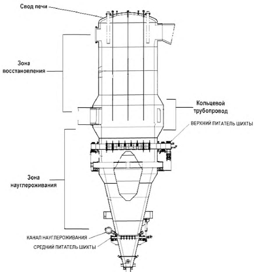
Рисунок 2.37 — Общий вид шахтной печи металлизации MIDREX
