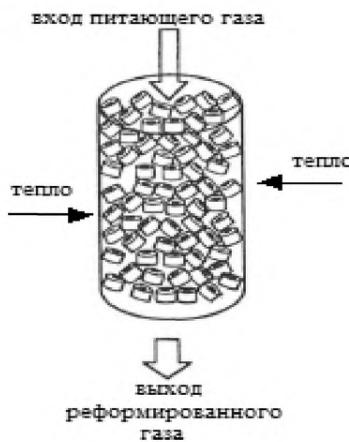
Рисунок 2.42 — Реакционная труба реформера, заполненная катализатором
