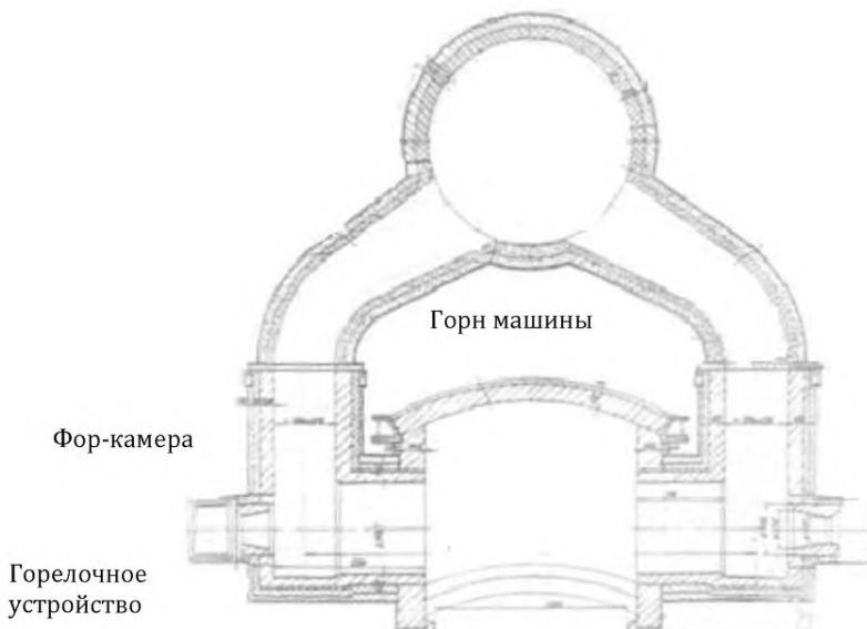
Рисунок 2.27 — Поперечное сечение горна обжиговой машины
