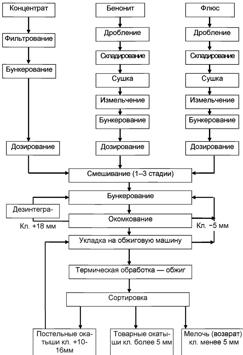
Рисунок 2.15 — Обобщенная структурная схема производства окатышей
