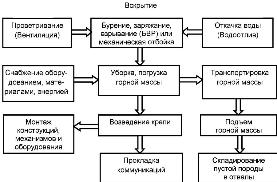
Рисунок 2.2 — Общая блок-схема процессов этапа вскрытия
