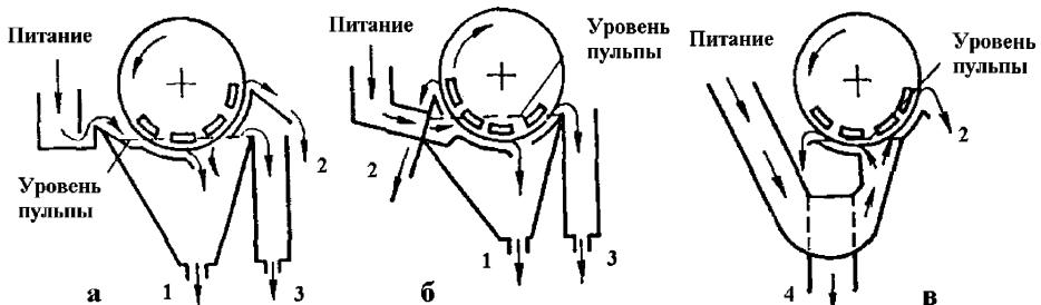
1 — зернистый немагнитный продукт; 2 — магнитный продукт; 3 — тонкозернистый немагнитный продукт; 4 — зернистый и тонкозернистый немагнитные продукты
