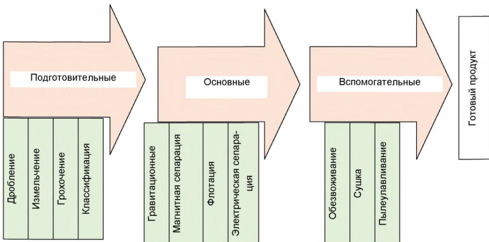
Рисунок 2.6 — Обобщающая схема технологического процесса обогащения
