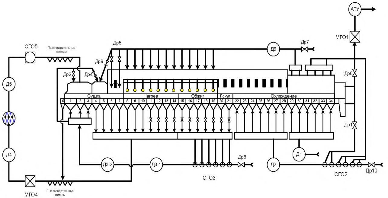
Рисунок 2.22 — Схема газовых потоков обжиговой машины ОК-306
