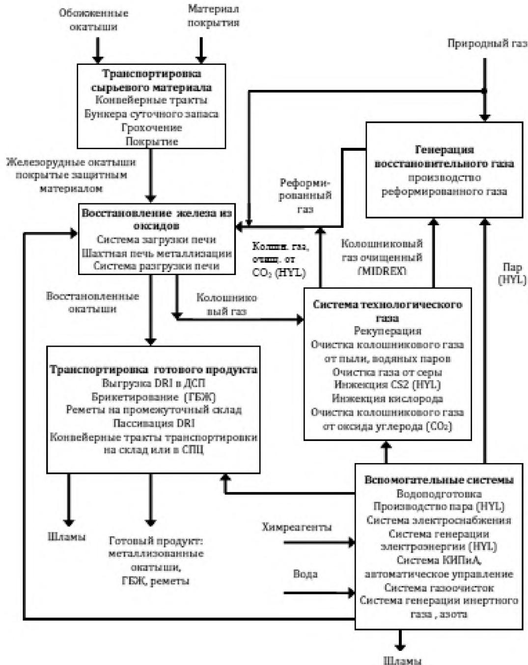
Рисунок 2.32 — Обобщенная технологическая схема производства железа прямого восстановления
