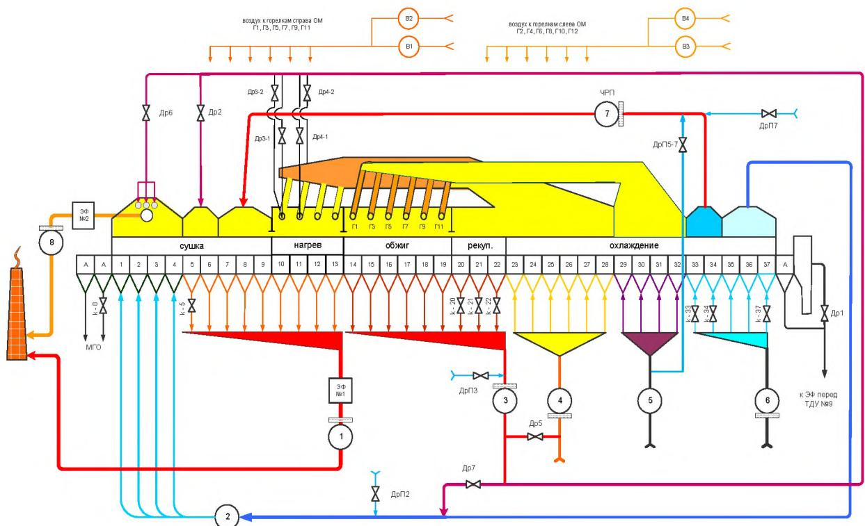
Рисунок 2.24 — Схема газовых потоков обжиговой машины
