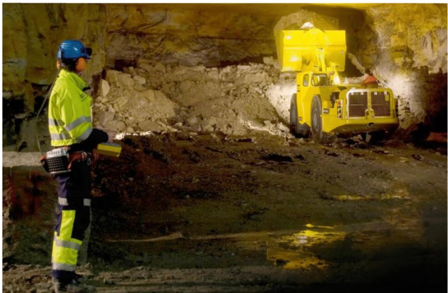
Рисунок 7.7 — Удаленное управление погрузочной машиной
