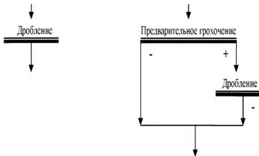
Рисунок 2.8 — Схемы одностадиального дробления в открытом цикле
