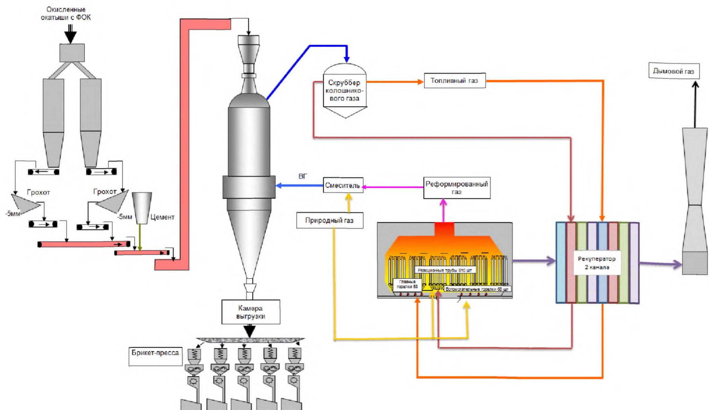
Рисунок 2.34 — Технологическая схема MIDREX
