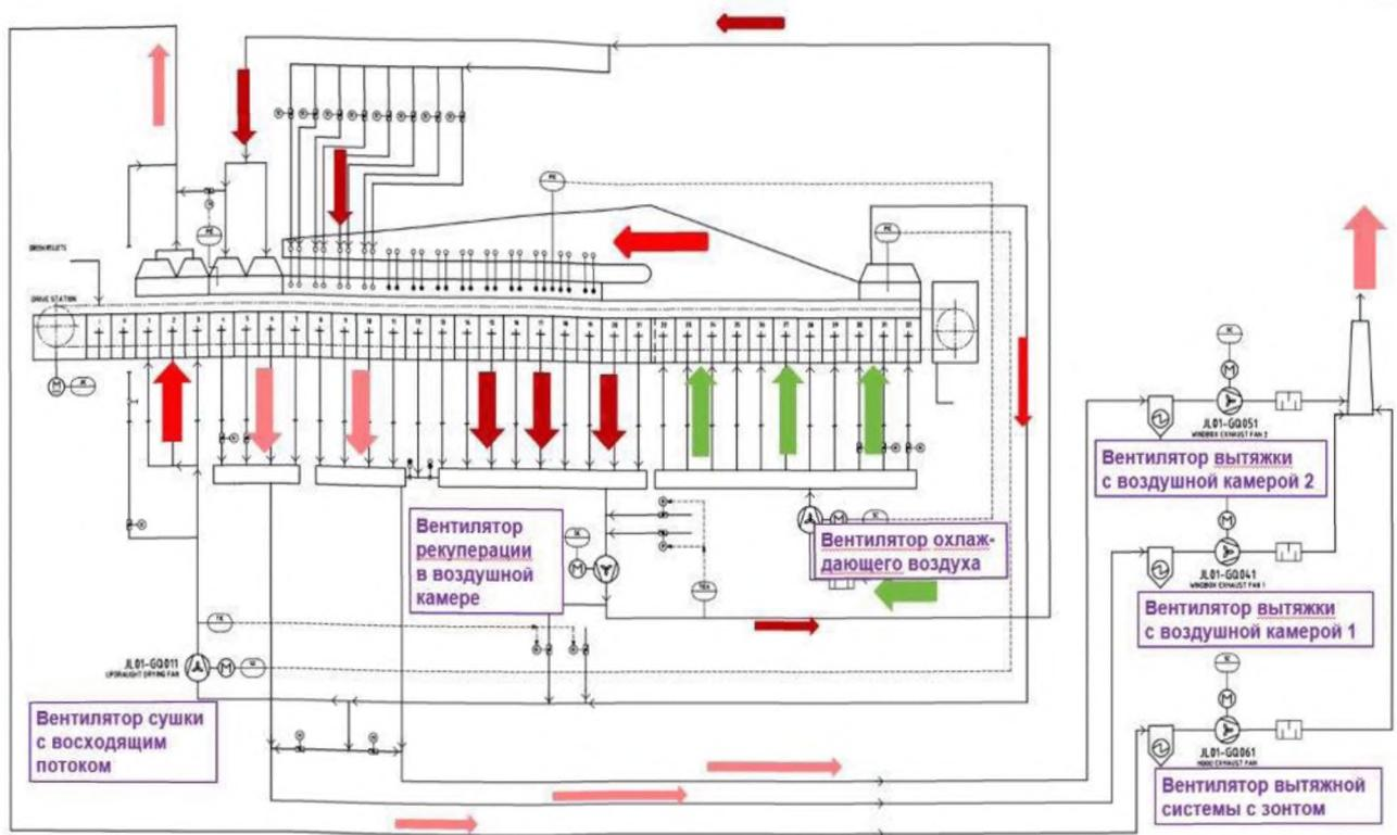
Рисунок 2.26 — Схема газовых потоков обжиговой машины О-768
