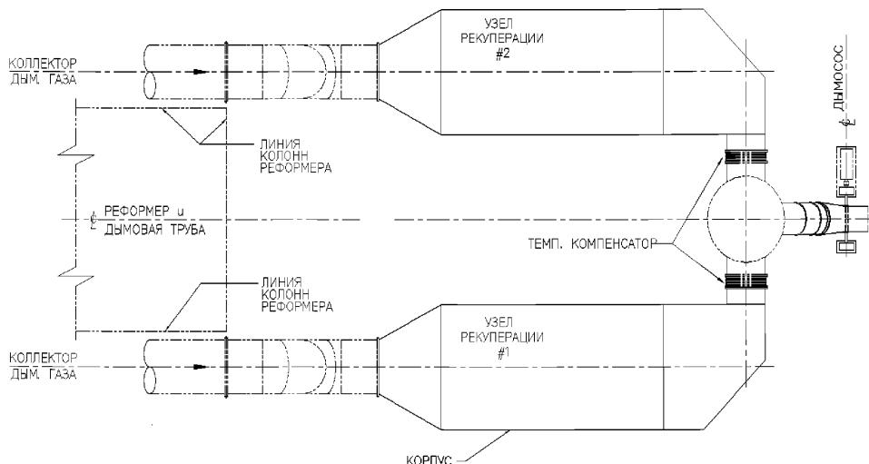
Рисунок 2.48 — Схема системы рекуперации тепла на установках MIDREX
