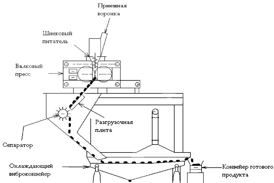
Рисунок 2.50 — Схема установки брикетирования и охлаждения брикетов
