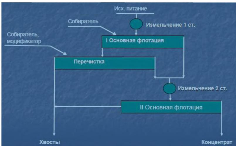
Рисунок 7.10 — Схема двухстадиального флотационного обогащения
