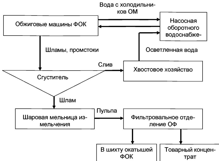
Рисунок 2.31 — Обобщенная схема движения шламов фабрик окомкования
