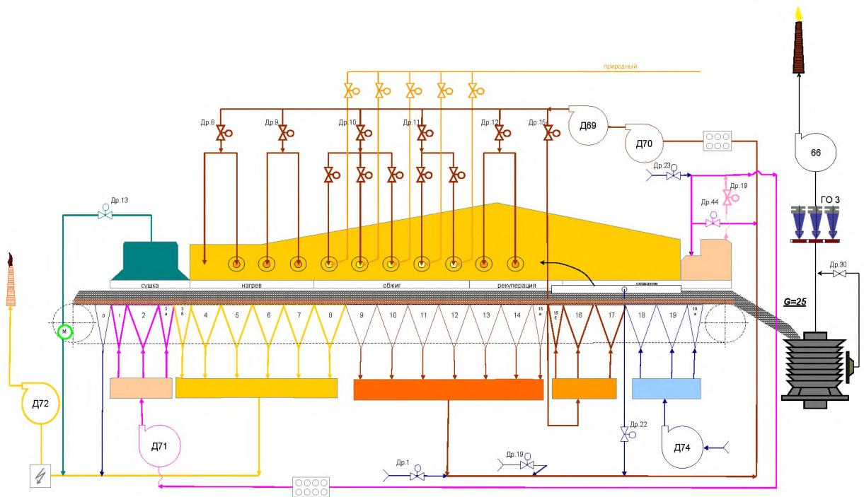
Рисунок 2.21 — Тепловая схема действующей модернизированной ОК-228
