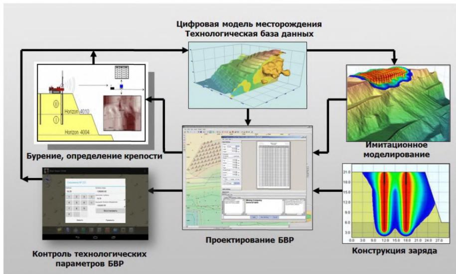
Рисунок 7.4 — Схема автоматизированной системы управления буровыми работами
