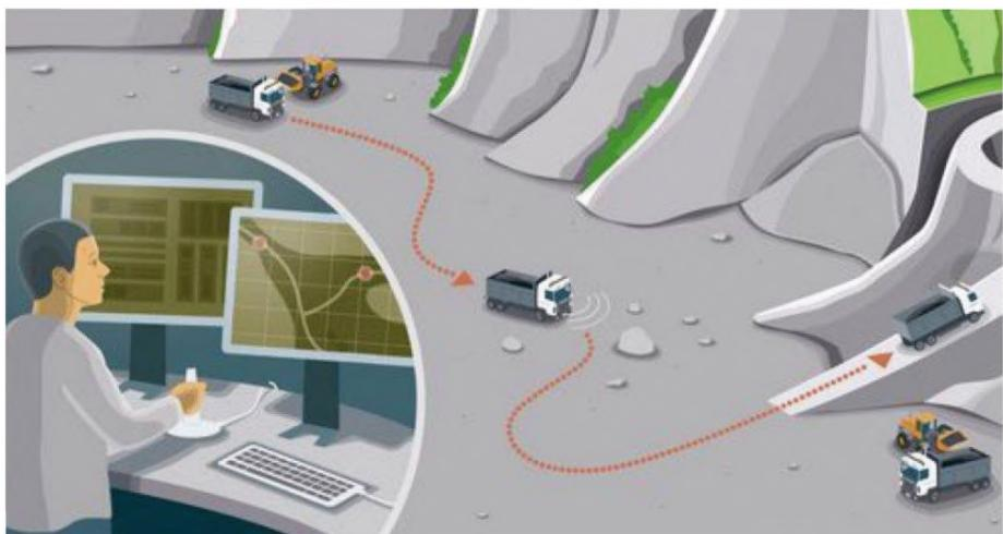
Рисунок 7.3 — Схема управления беспилотными автосамосвалами
