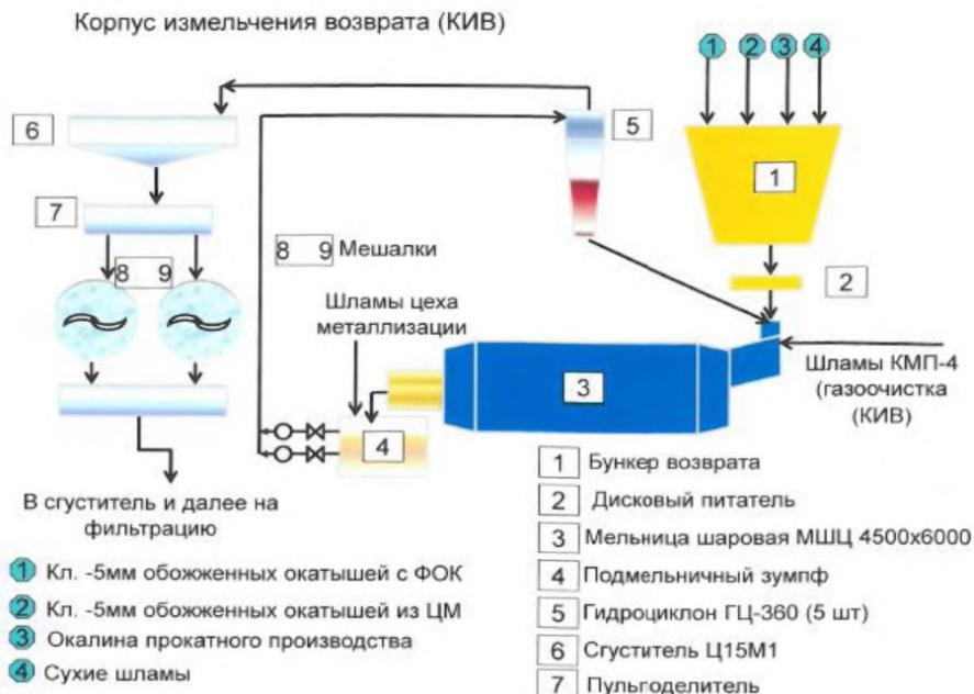
Рисунок 3.6 — Схема использования шламов на ОЭМК.
