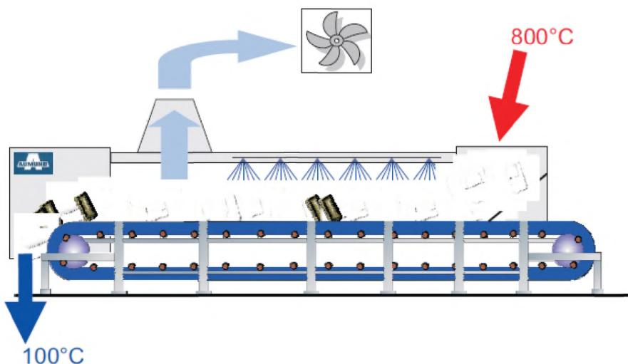
Рисунок 2.51 — Принцип действия конвейера медленного охлаждения
