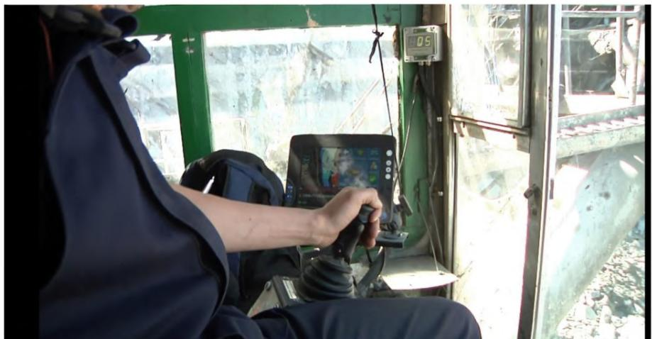
Рисунок 7.5 — Кабина экскаватора, оснащенная системой позиционирования ковша
