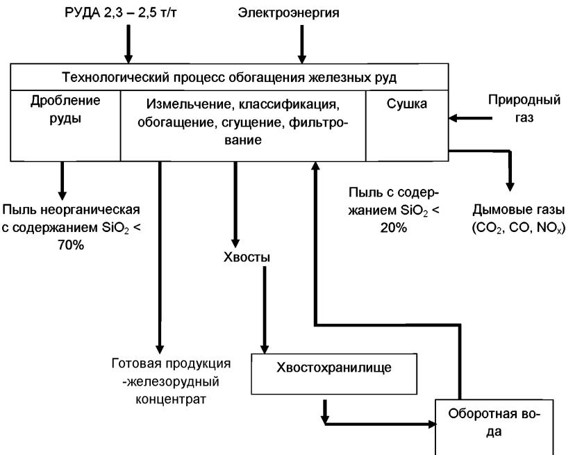
Рисунок 3.5 — Обобщенная схема движения шламов фабрик окомкования.
