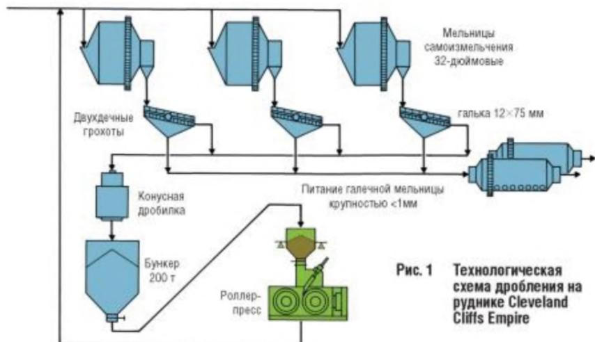
Рис. 1 Технологическая схема дробления на руднике Cleveland Cliffs Empire
