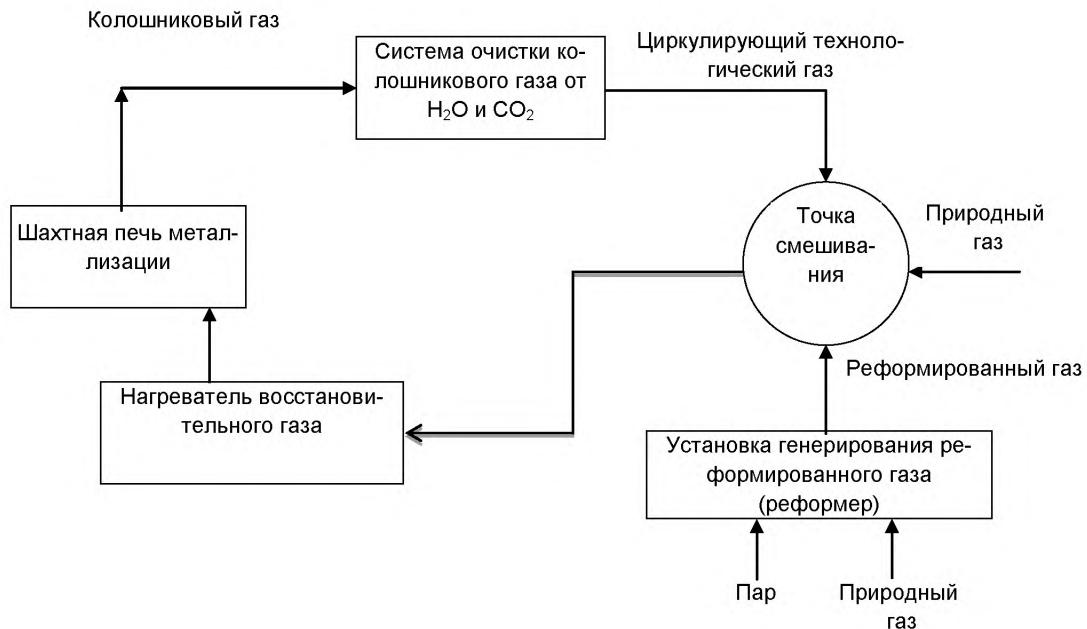
Рисунок 2.44 — Схема циркуляции технологического газа в системе HYL-III
