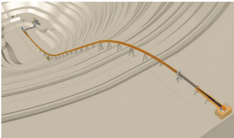
Рисунок 7.2 — Трехмерная схема крутонаклонного конвейера из карьера
