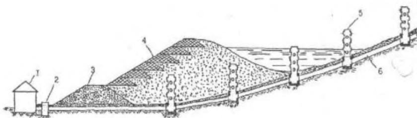
1 — станция обратного водоснабжения; 2 — водобойные колодцы; 3 — насыпная плотина; 4 — дамбы обвалования; 5 — водоприемные колодцы; 6 — водосбросной коллектор
