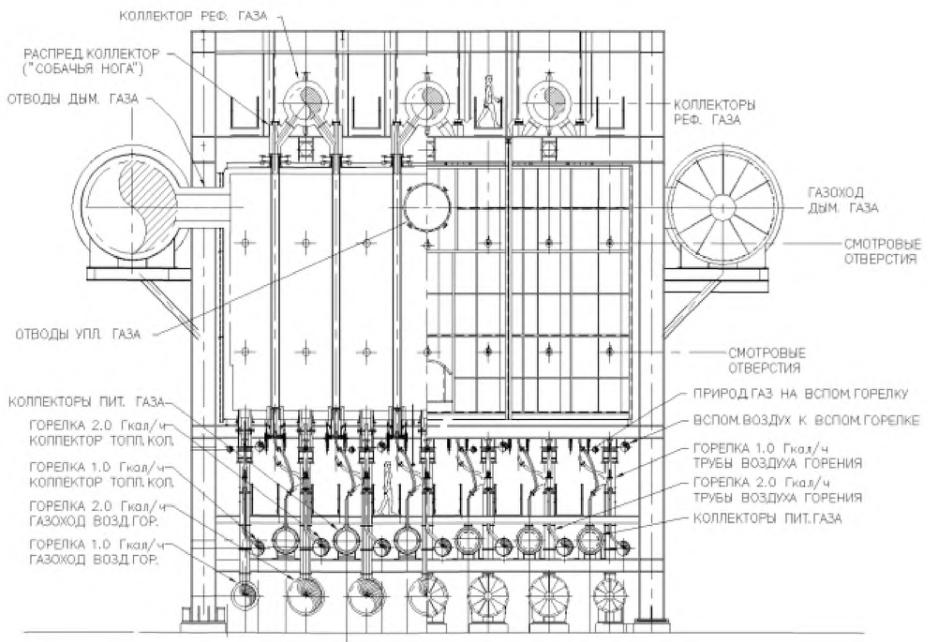
Рисунок 2.41 — Реформер установки MIDREX. Вид с торца
