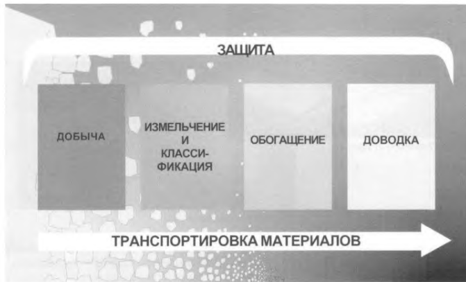
Рисунок 2.15 — Технологические этапы повышения содержания основных металлов в рудах и удаления вредных примесей
