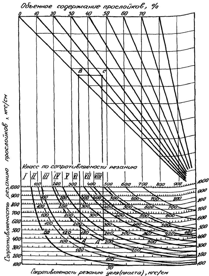
Рис. 1. Номограмма для определения сопротивляемости резанию пластов, содержащих прослойки
