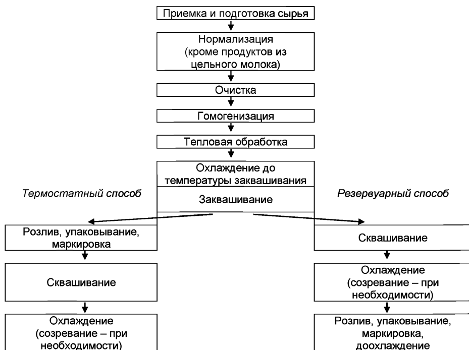
Рисунок 2.7 – Технологическая схема производства жидких кисломолочных продуктов и напитков
