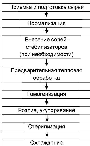
Рисунок 2.2 – Технологическая схема производства стерилизованного молока (сливок)
