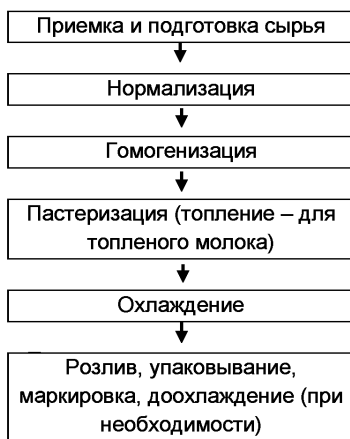
Рисунок 2.1 – Технологическая схема производства пастеризованного и топленого молока (пастеризованных сливок)
