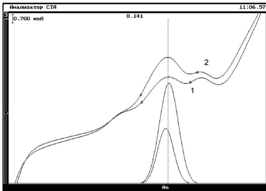
Рисунок 2. Вольтамперограммы измерения массовой концентрации мышьяка в пробе (1) и в пробе с добавкой АС (2)
