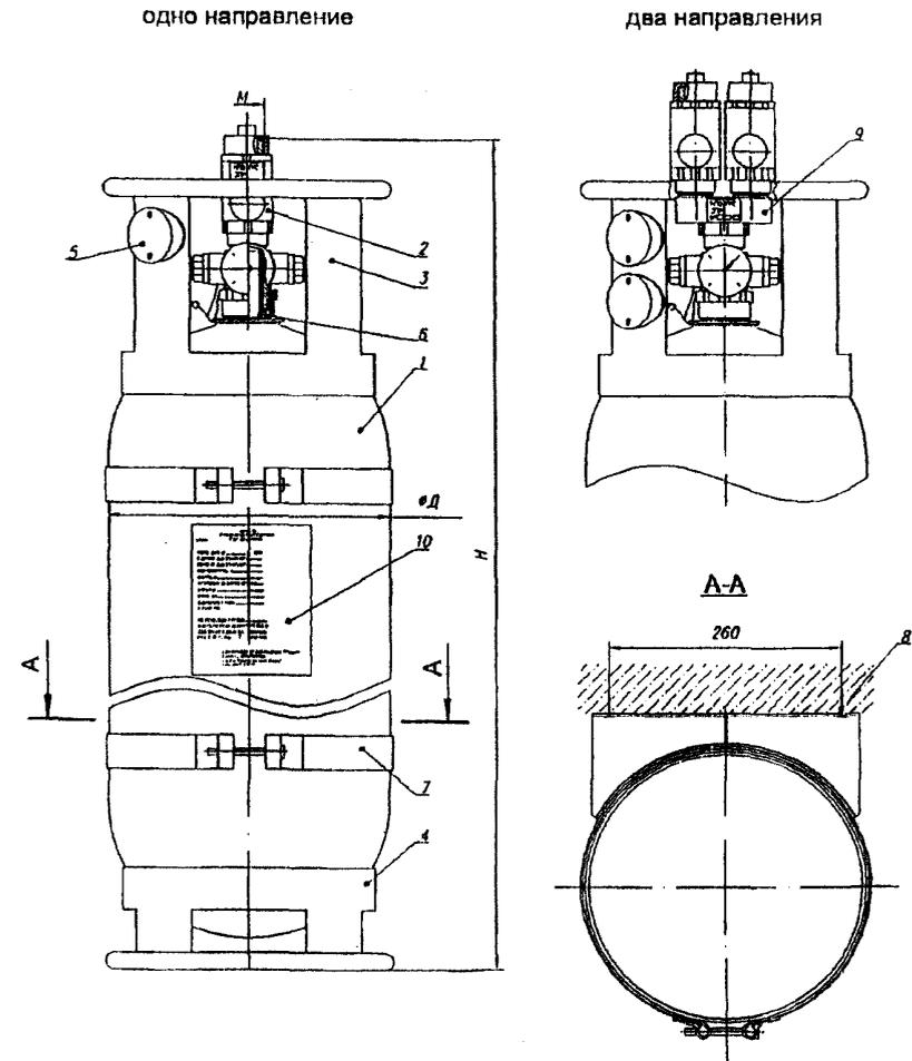
1-баллон; 2-запорно пусковое устройство; 3-верхний опорный узел; 4-башмак; 5-переходная колодка; 6-сифонная труба; 7-хомут с ложементом; 8-двобель; 9-разветвитель; 10-информационная табличка;
