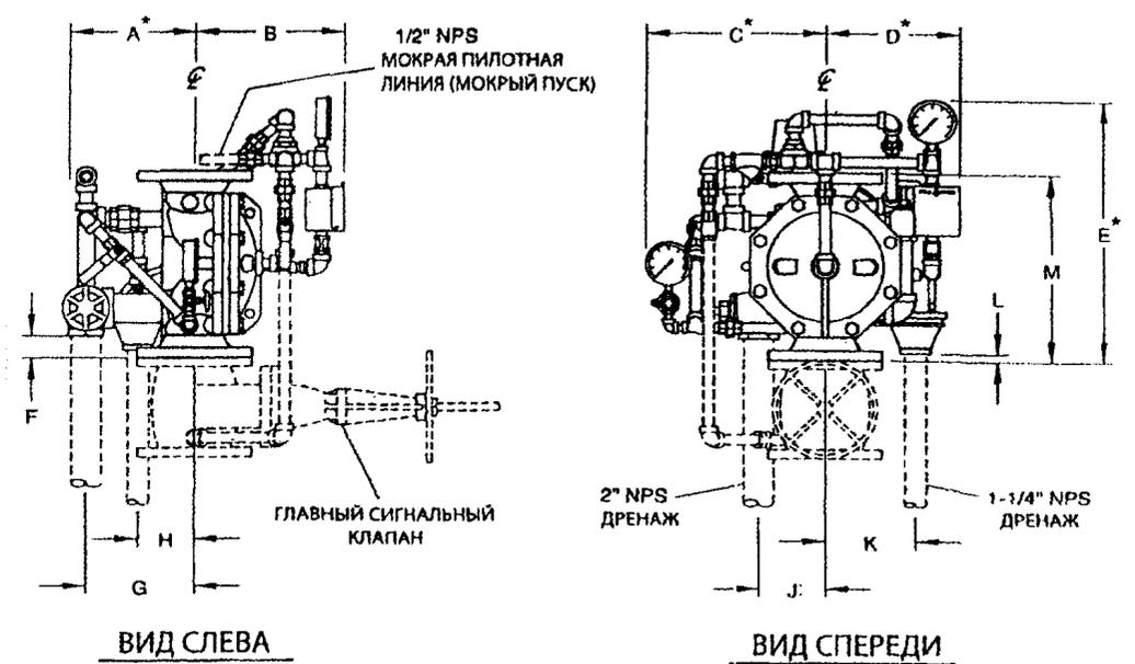
6.4. Установка пожаротушения воздушно-механической пеной УПВП «Прибой».
