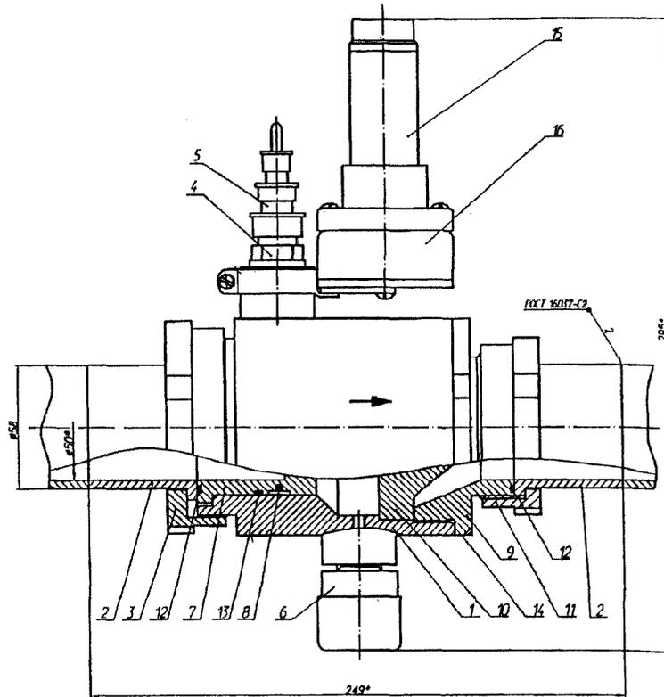
1—корпус; 2—приварной ниппель; 3—гайка накидная; 4—пусковое устройство ПУО-2; 5—разъем ПУО-2 (со жгутом); 6—сигнализатор давления СДГ; 7—разрывной элемент; 8—устройство вскрытия УВК; 9—выходной штуцер; 10—уловитель; 11—гайка накидная; 12,13,14 — уплотнительные кольца; 15—устройство ручного пуска УРП-7 или УСП101-Р; 16—переходная колодка.
