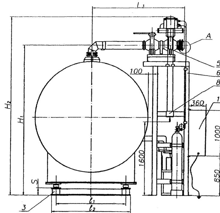
1 – Шкаф управления; 2 – Резервуар РЖУ; 3 – Опора резервуара; 4 – Агрегат холодильный (ХА);
