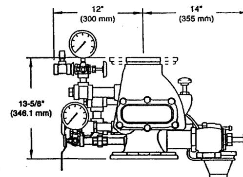
Номинальные установочные размеры клапана DPV-1 4" (Ду 100 мм)
