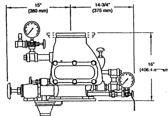
Номинальные установочные размеры клапана DPV-1 6" (Ду 150 мм)
