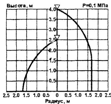
Коэффициент производительности по НПБ 88-2001:  $K=Q/\sqrt{H}$ , где  $Q$ [л/с] - расход,  $H$ [м<sub>в.с.</sub>] - напор перед оросителем
