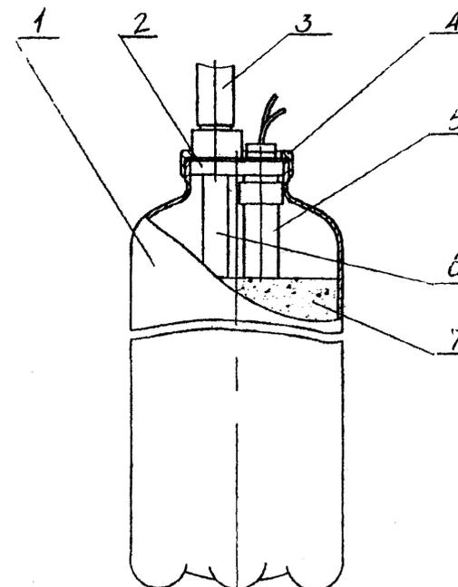
1 – корпус; 2 – пусковая головка; 3 – патрубок или распределительный трубопровод; 4 – накидная гайка; 5 – генератор газа ГПЭ; 6 – заборник; 7 – огнетушащее вещество.
