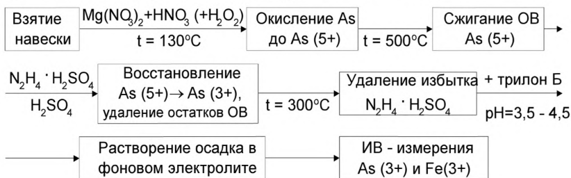
Схема 1. Основные этапы анализа проб алкогольных и безалкогольных напитков, питьевых и минеральных вод на содержание мышьяка и железа
