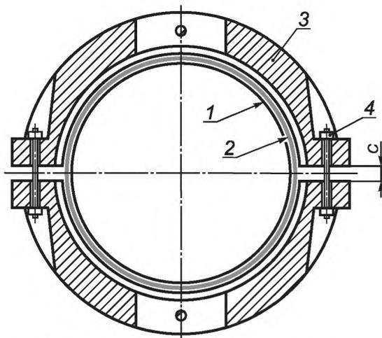
1 — трубопровод; 2 — футеровка; 3 — полугруз ЧБУ; 4 — крепежные изделия;
