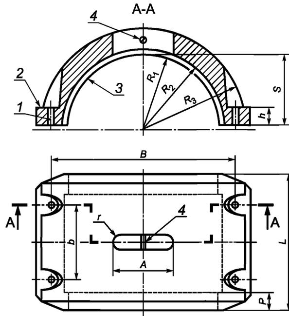
1 — отверстие для установки крепежных изделий; 2 — опорные поверхности под крепежные изделия;
