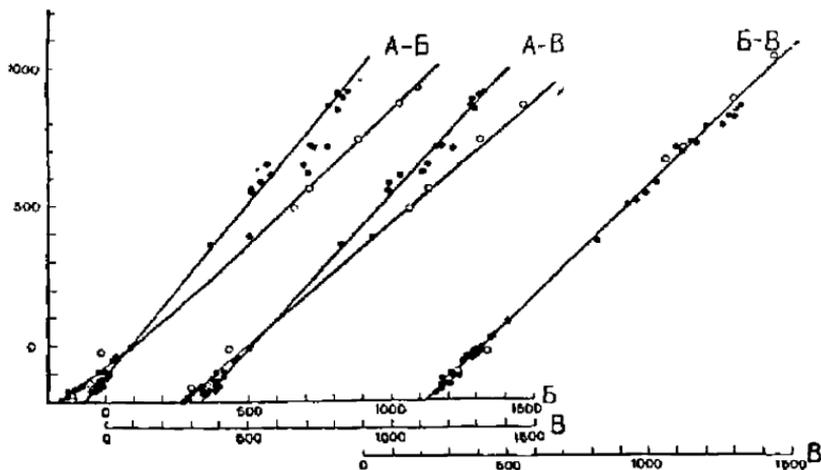
Рис. 3. Пример построения графиков зависимости между значениями характерного уровня воды по данным наблюдений смежных постов за ряд лет.
