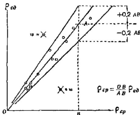
Рис. 39. Связь средней мутности реки и мутности единичных проб воды.
