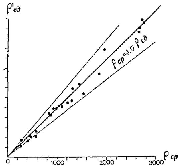
Рис. 48. Связь между средней мутностью реки и мутностью единичных проб, взятых на разных вертикалях.
