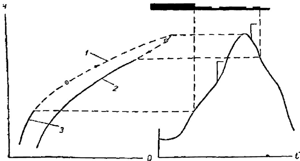
Рис. 22. Пример кривой расходов воды периода весеннего вскрытия.
