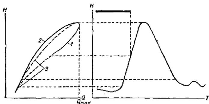
Рис. 10. Петлеобразная кривая расходов (схема).
