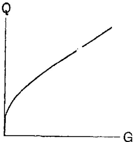
Рис. 42. График связи между значениями расхода воды и расхода донных наносов.
