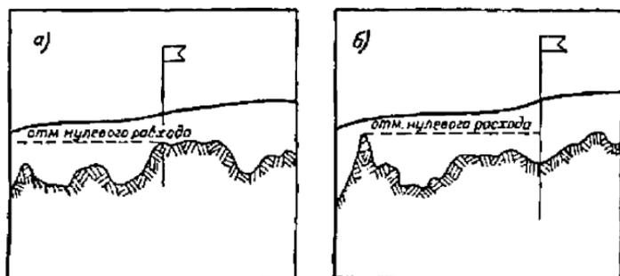
Рис. 9. Определение отметки нулевого расхода.
