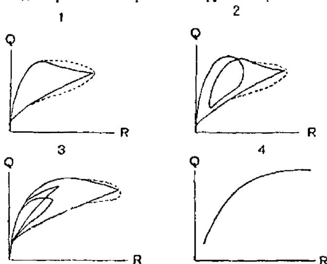
Рис. 41. Типичные случаи связи между значениями расхода воды и расхода взвешенных наносов.
