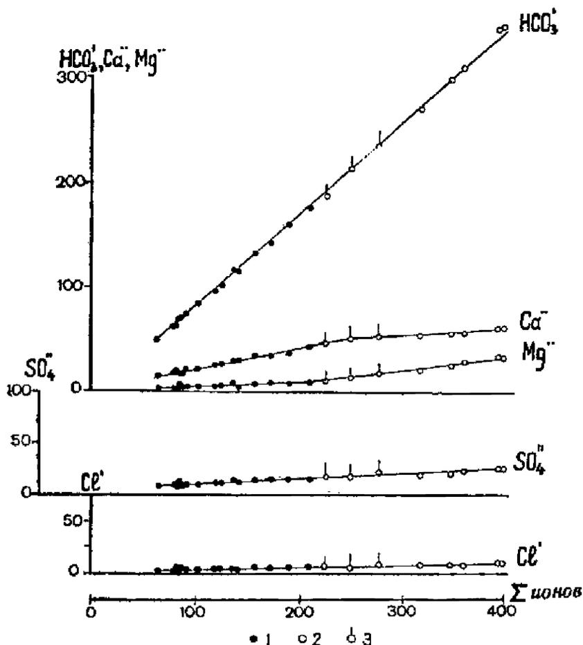
Рис. 49. Связь между суммой ионов и содержанием одного иона, входящего в эту сумму.
