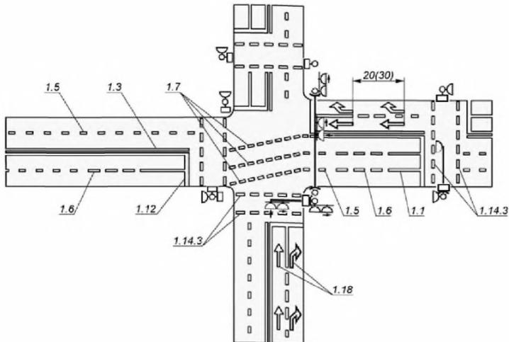
Рисунок А.6 - перед перекрестками, видимость на которых соответствует требованиям действующих строительных норм и правил, и при интенсивности движения по пересекающей дороге
