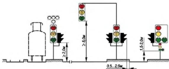
Рисунок А.23 - Самостоятельный светофор
