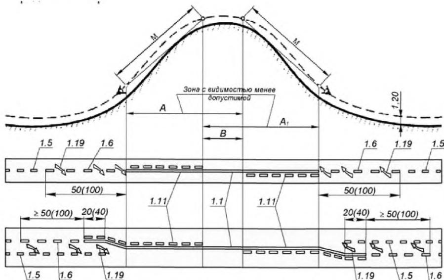
$M$  - минимальное расстояние видимости, обеспечивающее безопасность движения при данной скорости,  $m$ .
