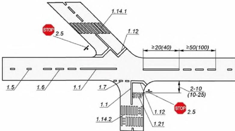
Рисунок А.5 - перед перекрестками, видимость на которых не соответствует требованиям действующих строительных норм и правил, и при интенсивности движения по пересекающей дороге
