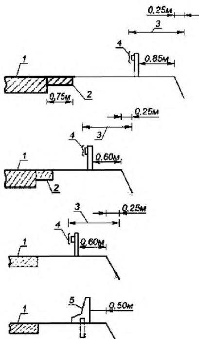
1) проезжая часть, 2) краевая укрепительная полоса, 3) расчетный поперечный прогиб ограждения, 4) барьерное одностороннее металлическое ограждение 5) парапетное одностороннее ограждение
