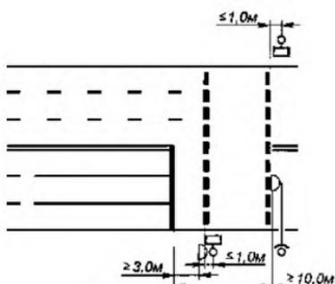
Рисунок А.25 - Расположение светофоров
