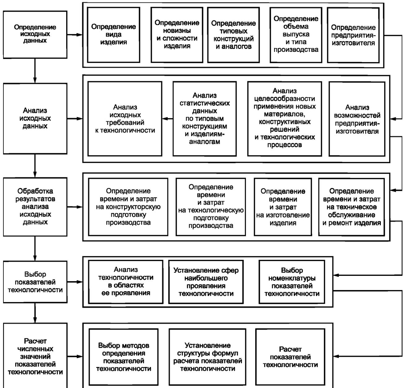
Рисунок 1 — Блок-схема определения показателей технологичности
