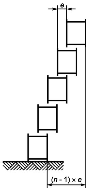
с) Смещения, приводящие к поперечным отклонениям
