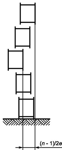
д) Смещения, приводящие к изгибным отклонениям
