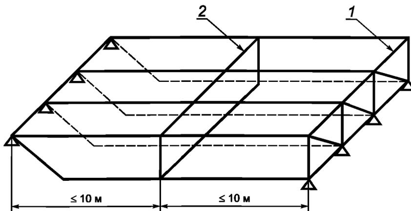
1 — крайние поперечные связи; 2 — промежуточные поперечные связи
