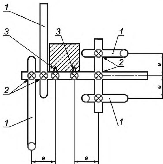
1 — диагонально расположенная труба; 2 — соединительная муфта; 3 — одиночный хомут для крепления к колонне;
