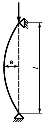
а) Вид сбоку раскрепленной стойки
