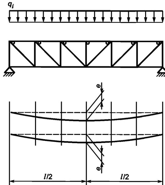
б) Вид сбоку и вид в плане шарнирно опертой фермы
