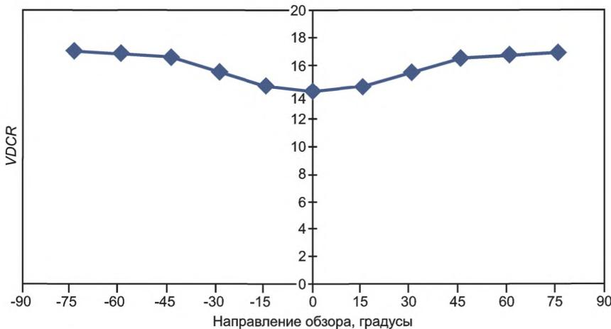
Рисунок 14 — Пример зависимости контрастности от направления обзора
