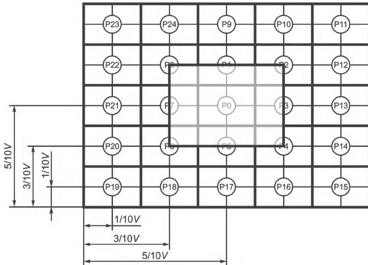
Рисунок 9 — Прямоугольное окно при измерении перекрестной помехи
