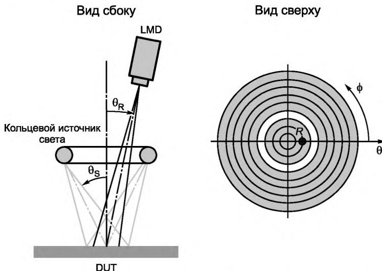
Рисунок 4 — Пример измерительной установки с освещением кольцевым светильником
