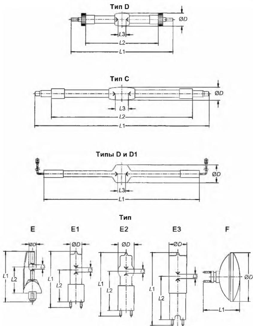
Рисунок 1 – Типы и установочные размеры ламп
