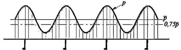
Рис. 10.5.1-1 Распределение ледовой нагрузки по борту судна
