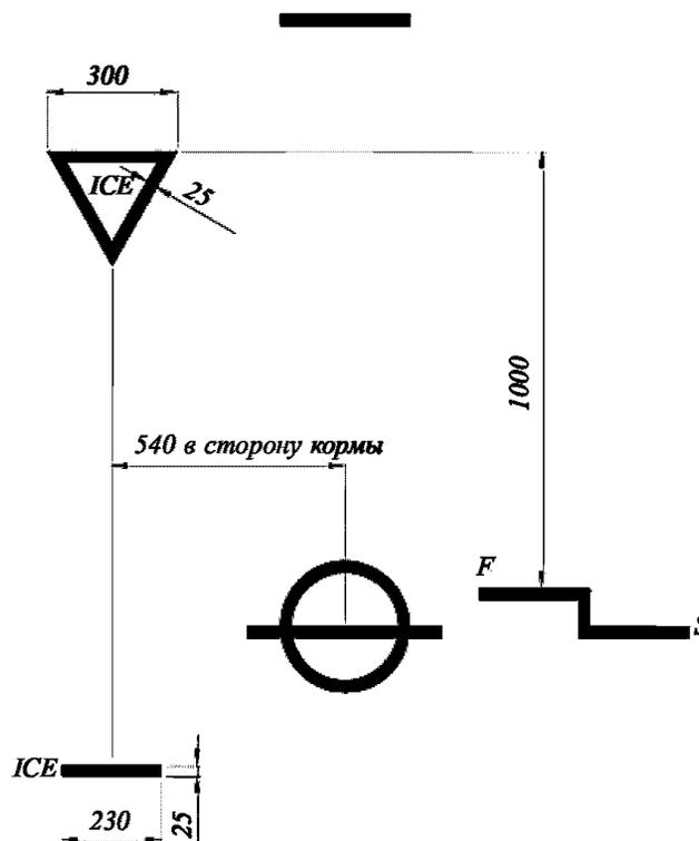
Рис. Марка осадок судна ледового класса
