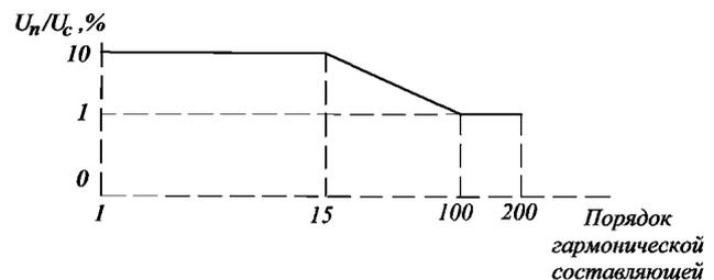
Рис. 2.2.1.2.2 График высших гармонических составляющих судовой сети
