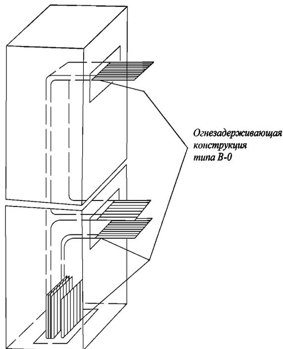
Рис. 16.8.4.3.1 Защита полностью закрытой кабельной трассы типа В-0
