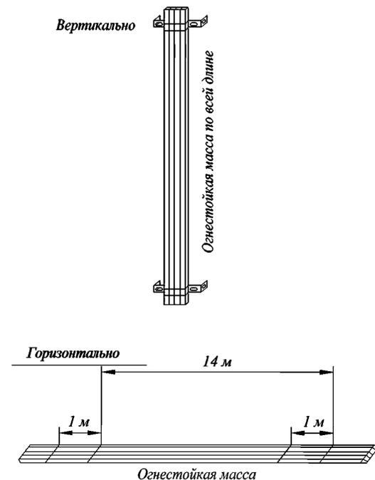
Рис. 16.8.4.3.2-1 Защита кабельной трассы огнестойкой массой
