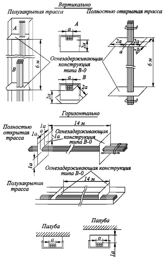
Рис. 16.8.4.3.2-2 Защита кабельных трасс огнезадерживающими конструкциями типа В-0
