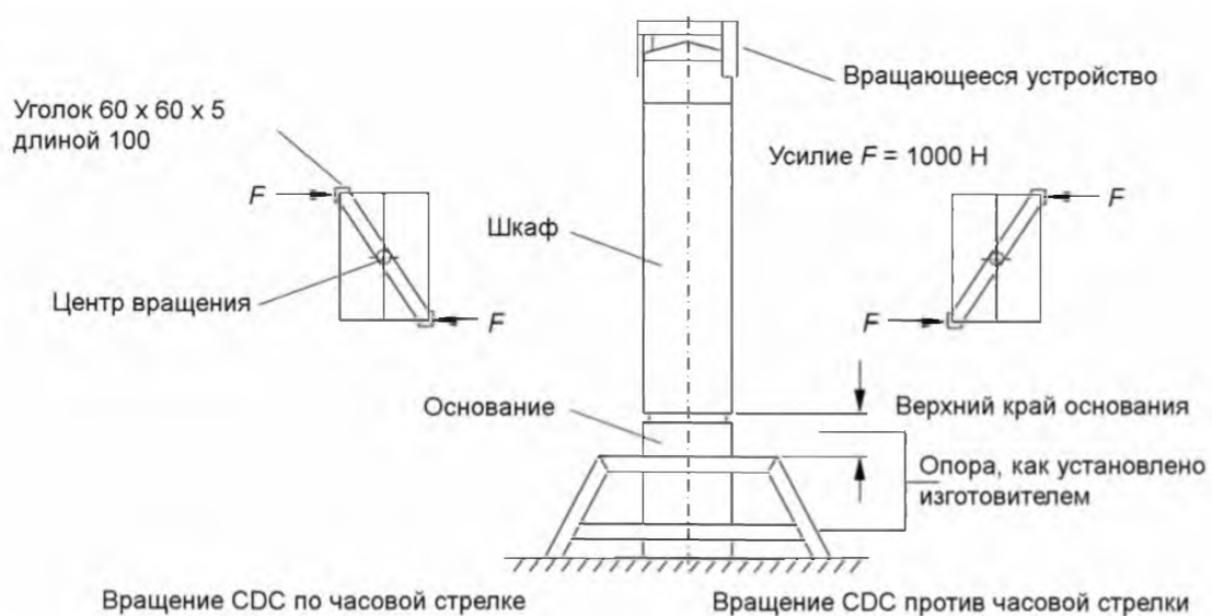
Рисунок 105а – Схема испытания устойчивости CDC к крутящей нагрузке
