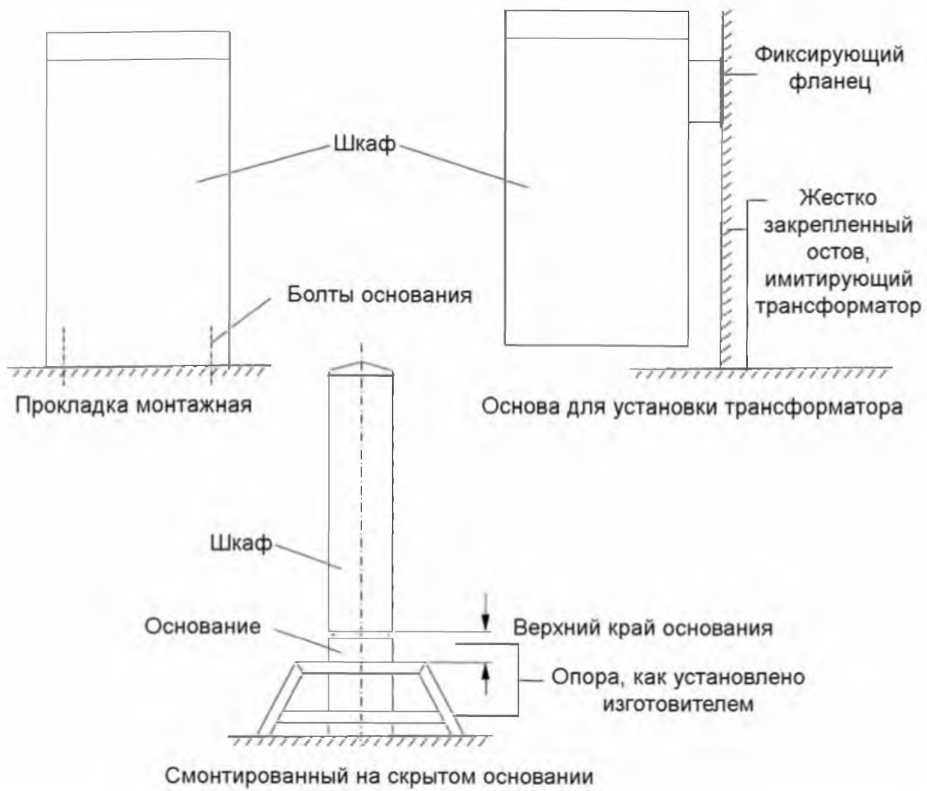
Рисунок 109 – Типовое оборудование для SCDB-CCO и SCDB-TMO испытаний на механическую прочность
