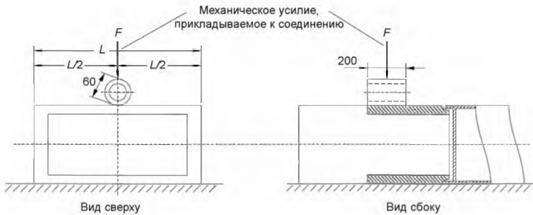
Рисунок 110 – Типовое испытательное оборудование для проверки механической прочности основания
