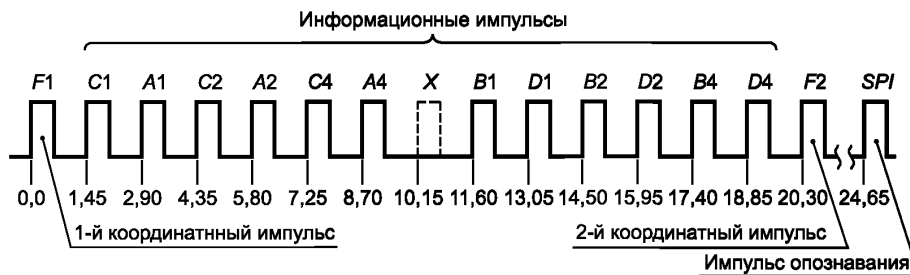
Рисунок 3 — Временная структура сигналов ответа режима RBS
