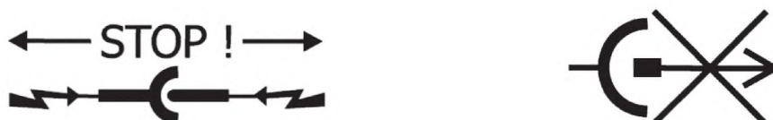
Рисунок В.4 — Примеры знака «Под напряжением! Не разъединять»
