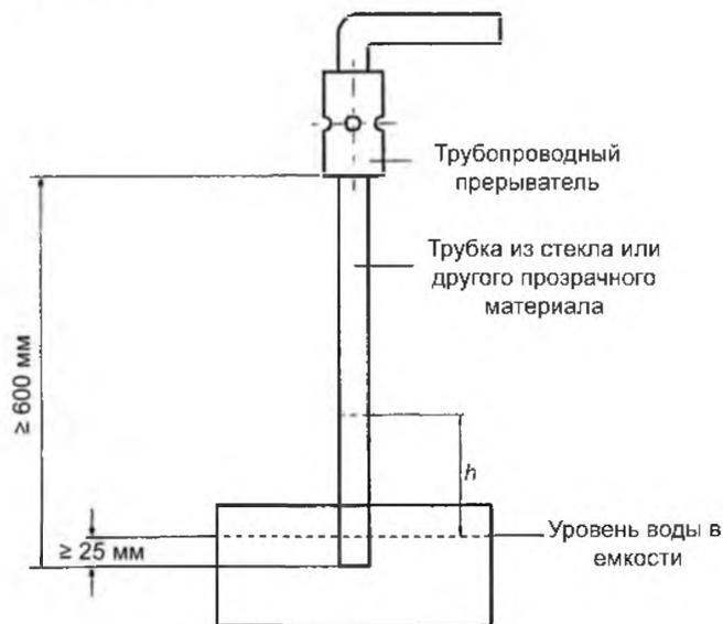
Рисунок 1 – Измерение расстояния  $h$  для трубопроводных прерывателей
