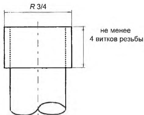
Рисунок 5 – Оправка для испытания соединительных гаек
