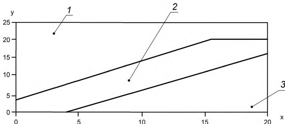
$x$  — ожидаемое число частиц  $E$ ;  $y$  — наблюдаемое число частиц  $C$ ; 1 — счет прекращается, чистота воздуха в пробе не соответствует заданным требованиям ( $C \geq 3,96 + 1,03E$ ); 2 — счет продолжается; 3 — счет прекращается, чистота воздуха в пробе соответствует заданным требованиям ( $C \leq -3,96 + 1,03E$ )
