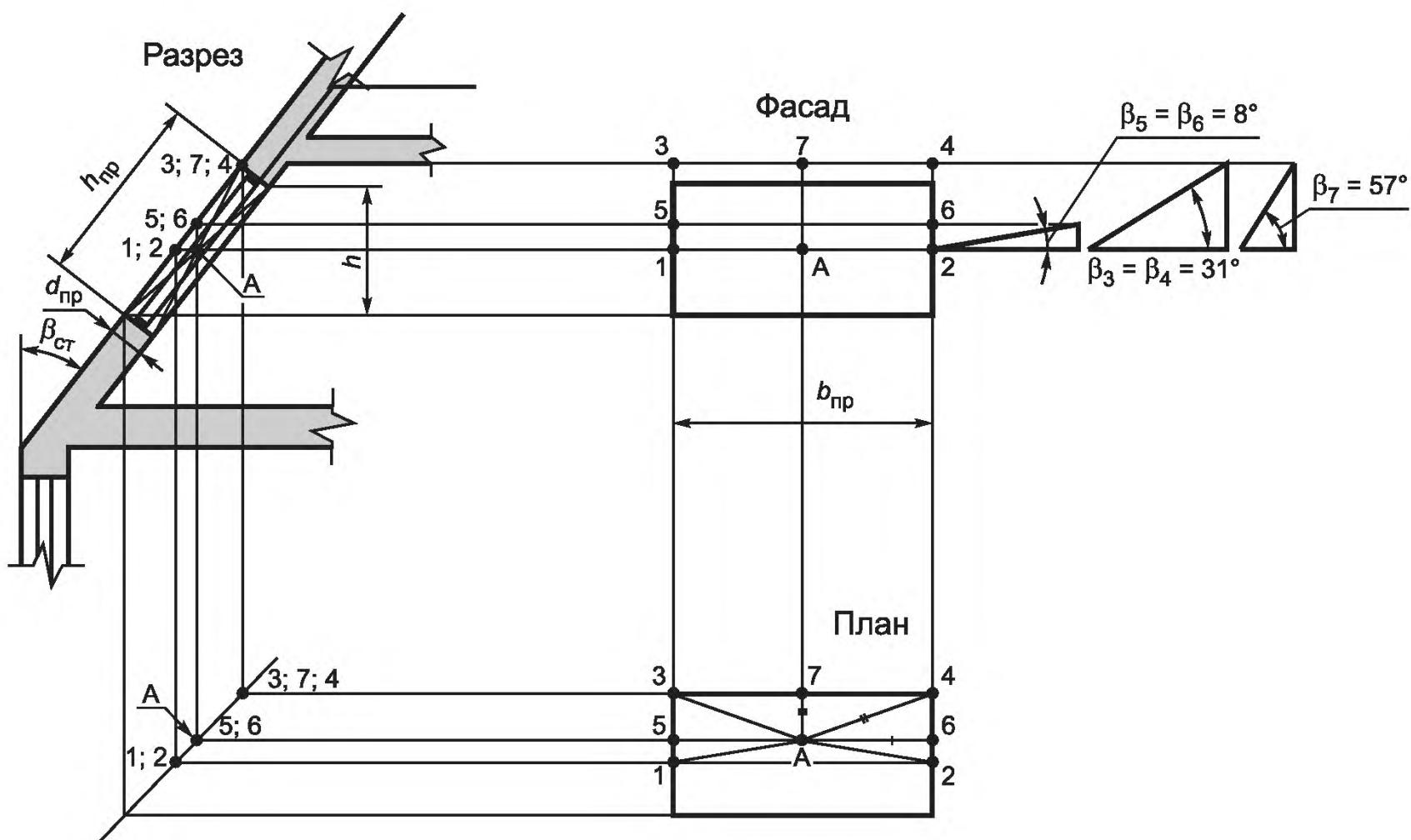
$A$  — расчетная точка помещения;  $h_{\text{пр}}$  — высота оконного проема;  $h$  — вертикальная составляющая высоты оконного проема;  $d_{\text{пр}}$  — условная глубина оконного проема;  $b_{\text{пр}}$  — ширина оконного проема;  $\beta_{\text{ст}}$  — угол наклона стены относительно вертикала;  $\beta_3; \beta_4; \beta_5; \beta_6$  — соответственно вертикальные теневые углы оконного проема в направлениях А-3; А-4; А-5; А-6 в плане
