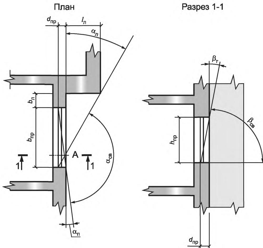
*A* — расчетная точка помещения;  $\alpha_{\text{л}}$ ,  $\alpha_{\text{n}}$  — левый и правый горизонтальные теневые углы оконного проема соответственно;  $\alpha_{\text{cb}}$  — горизонтальный световой угол оконного проема;  $\beta_{\text{T}}$ ;  $\beta_{\text{cb}}$  — вертикальные теневые и световые углы оконного проема соответственно
