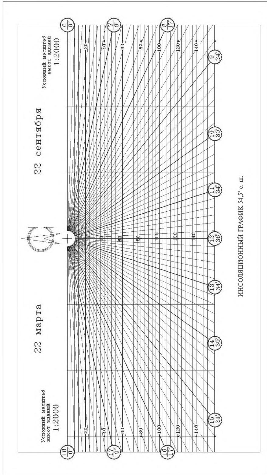
Рисунок В.14 — Инсоляционный график для города Москвы ( $54,5^{\circ}$  с. ш.) в масштабе 1:2000
