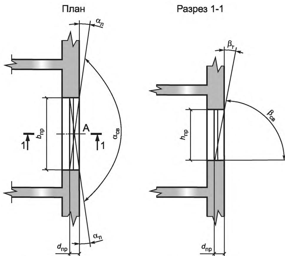
$A$  — расчетная точка помещения;  $\alpha_L$  — левый горизонтальный теневой угол оконного проема;
