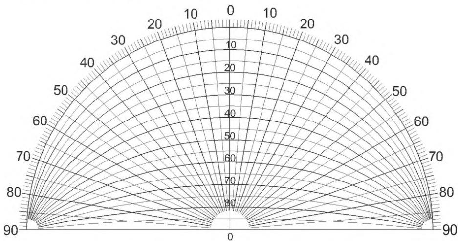
Рисунок Г.1 — Теневой угломер (контурная сетка) для солнечных карт
