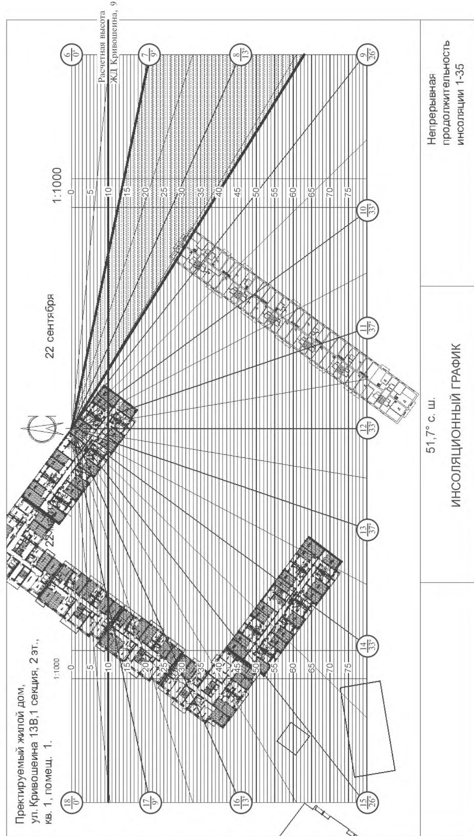
Рисунок Д.1 — Пример представления результатов графического расчета продолжительности инсоляции с помощью инсоляционного графика
