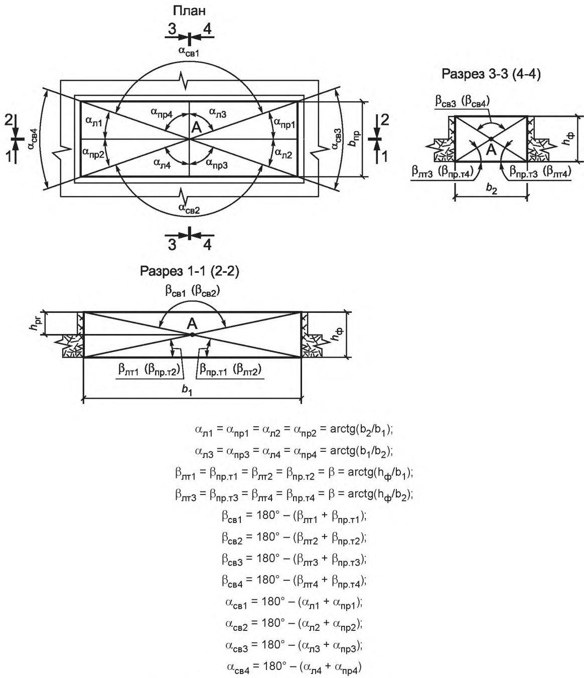
Рисунок А.7 — Схема определения теневых и световых углов
