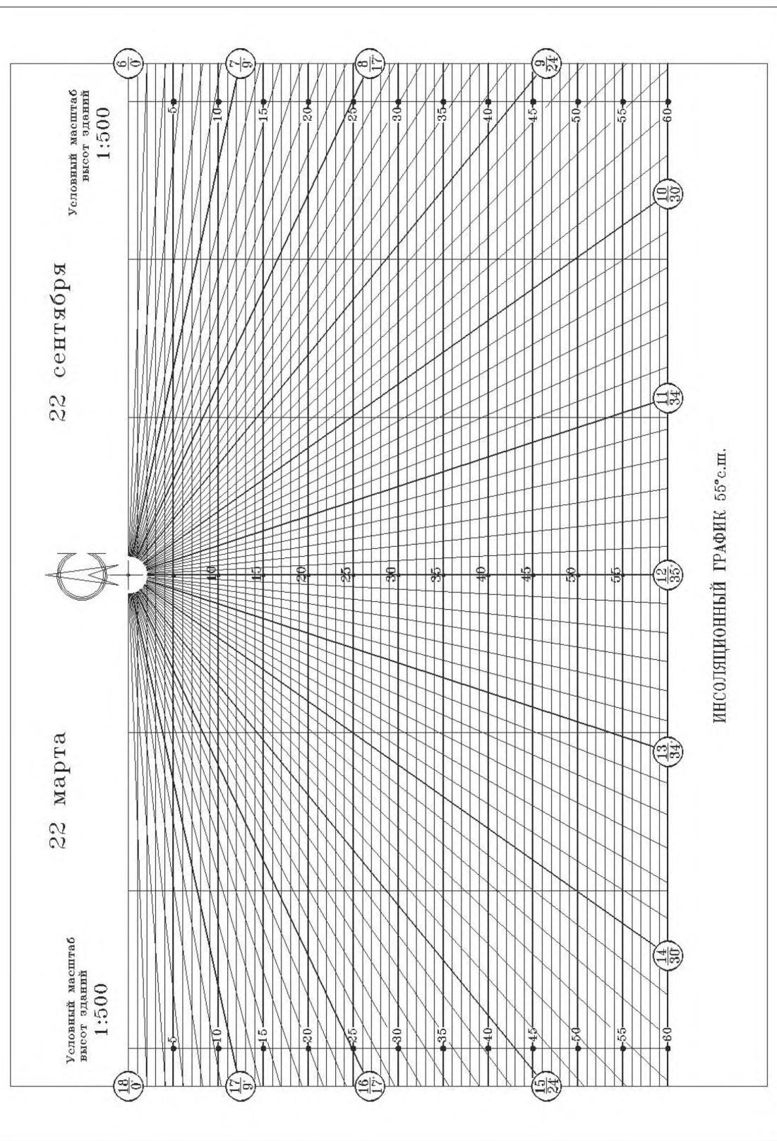
Рисунок В.15 — Инсоляционный график для города Москвы ( $55^{\circ}$  с. ш.) в масштабе 1:500
