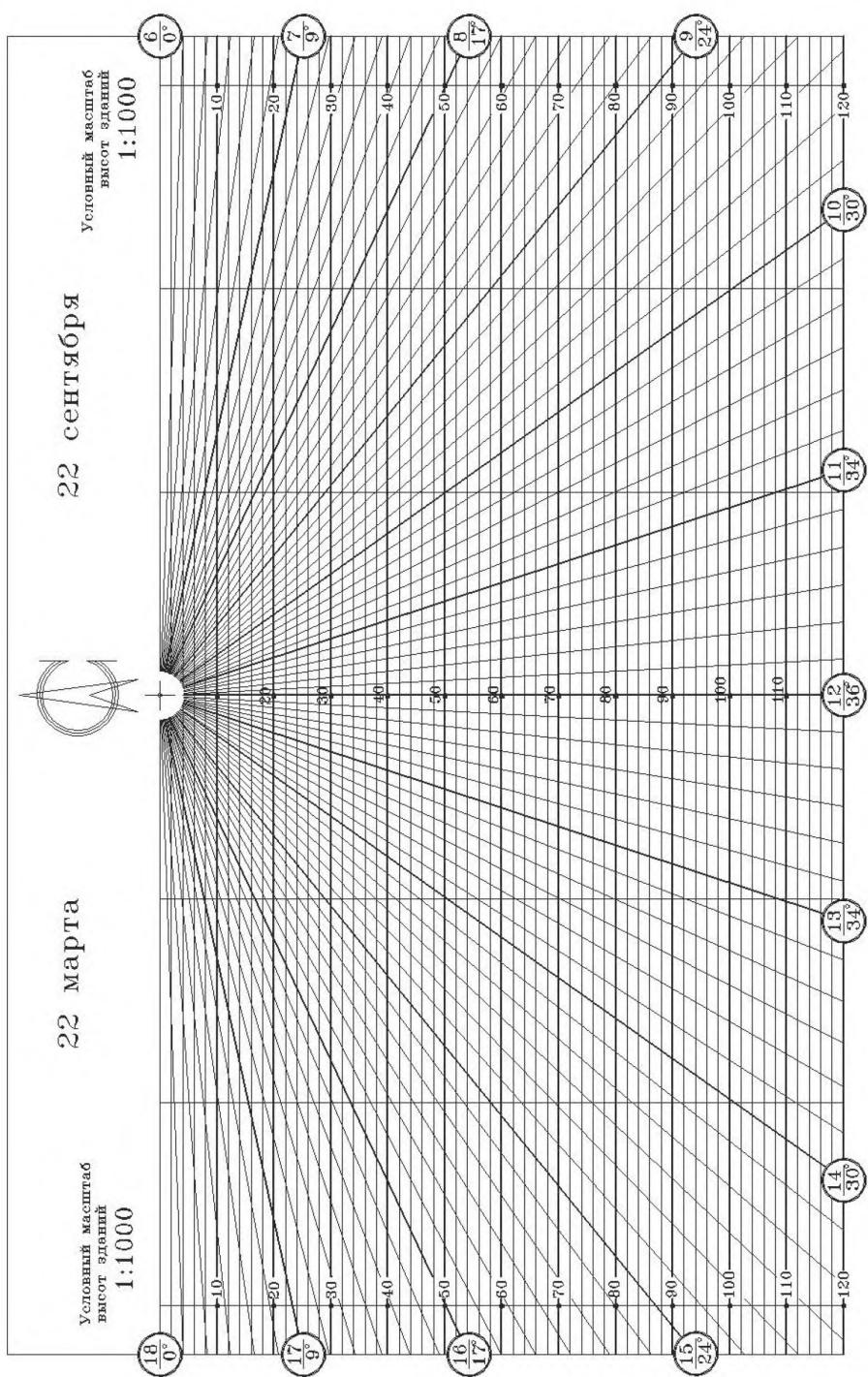
Рисунок В.13 — Инсоляционный график для города Москвы ( $54,5^{\circ}$  с. ш.) в масштабе 1:1000
