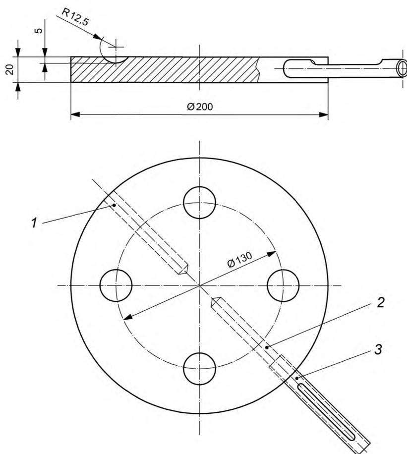
1 — отверстие для термопары устройства контроля температуры; 2 — отверстие для термометра;
