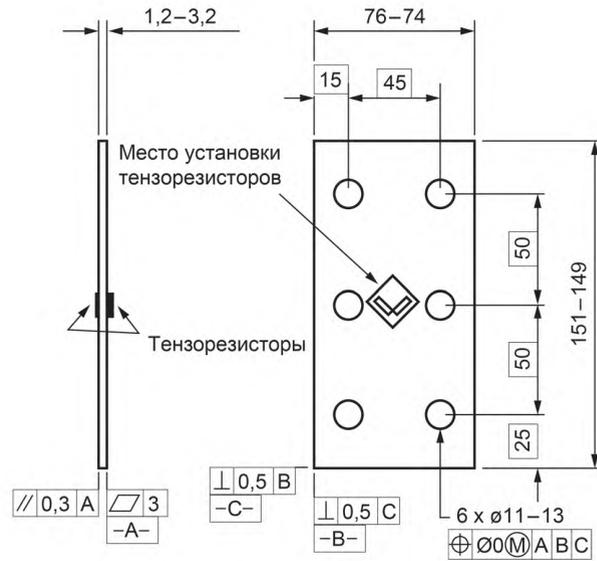
Рисунок 6 — Метод А. Образец, размеры в мм
