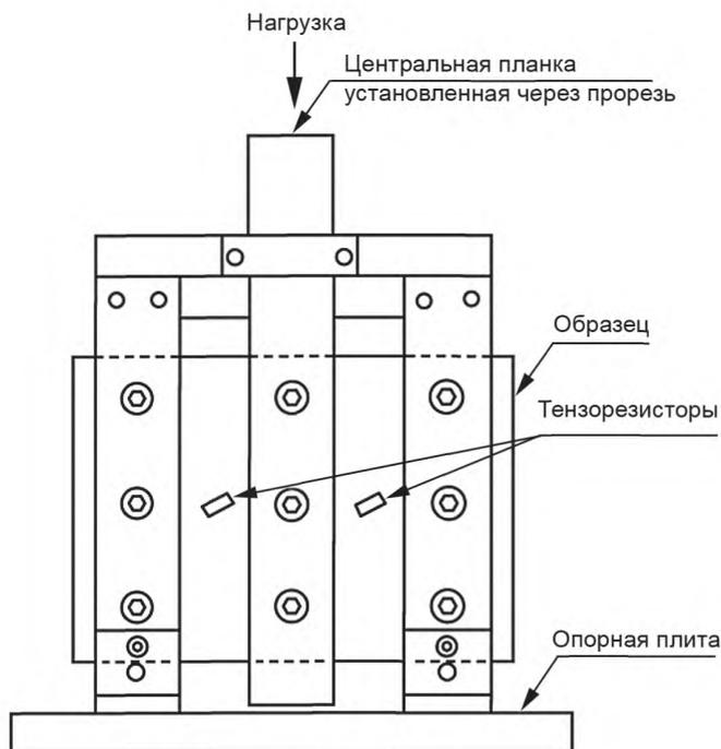
Рисунок 3 — Метод В. Эскиз приспособления
