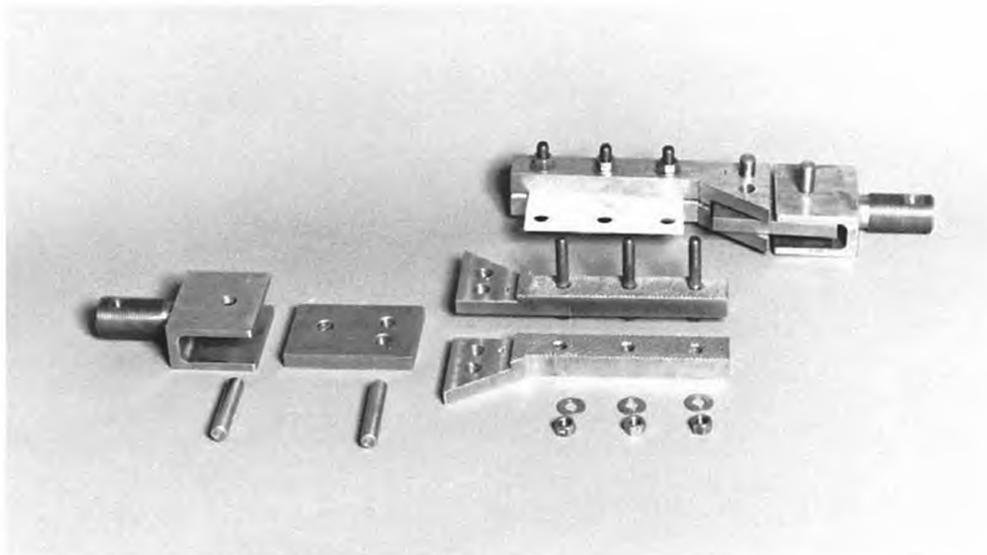
Рисунок 2 — Метод А. Детали приспособления
