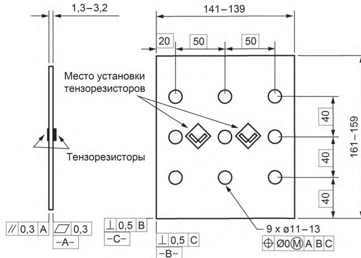
Рисунок 8 — Метод В. Образец, размеры в мм
