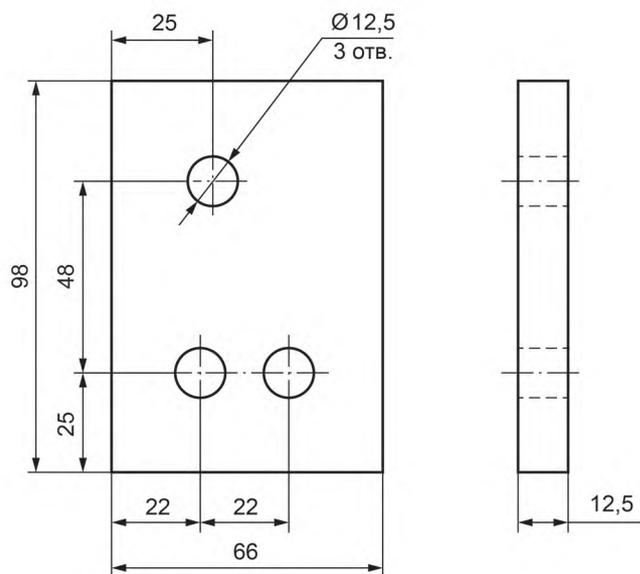
Рисунок ДА.3 — Эскиз выравнивающей пластины
