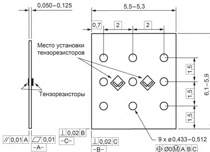
Рисунок 9 — Метод В. Образец, размеры в дюйм-фунт
