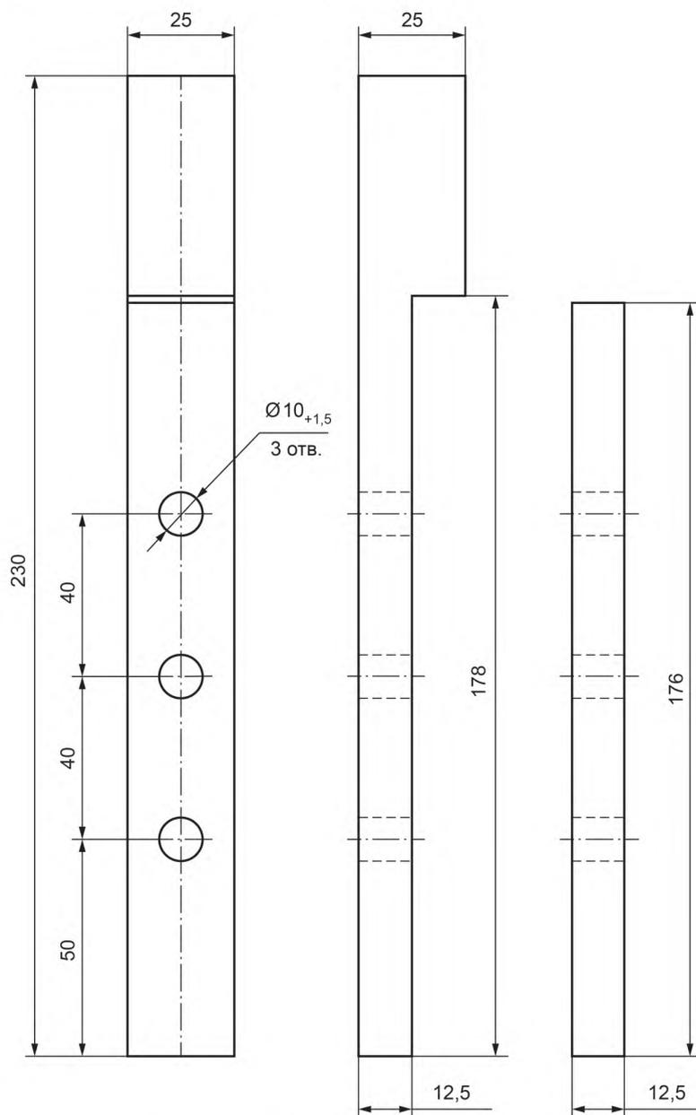
Рисунок ДБ.1 — Эскиз центральной пары планок
