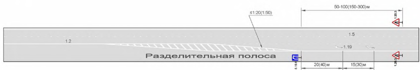
Рисунок Г.25 – Примеры применения элементов обустройства в местах уменьшения количества полос движения, лист 1
