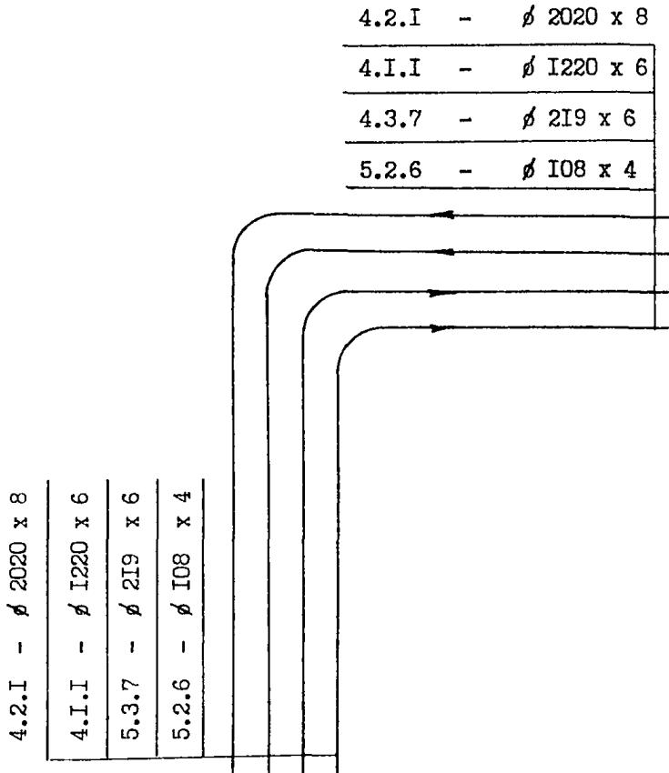
8. Направление потока газа должно указываться стрелкой на схемах, по крайней мере, в одном-двух местах.
